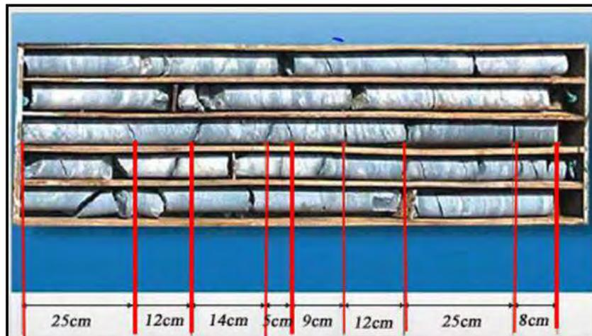
**Figura 29:** Datos tomados en riolita porfírica para el procedimiento para la medición del RQD (Deere, 1966), (Fuente: Superintendencia Mina Cuajone – SPCC).
