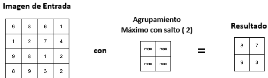
Figura 2.27 Agrupación máxima con stride 2 en una imagen de entrada
