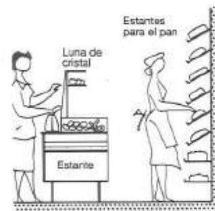
6 Puesto de venta con pantalla de separación
