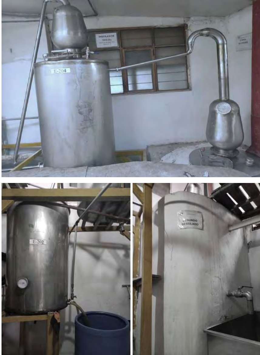
Figura 28: Equipo de destilador de 500 litros de vista frontal, vista del sistema de enfriamiento y vista del calderín
