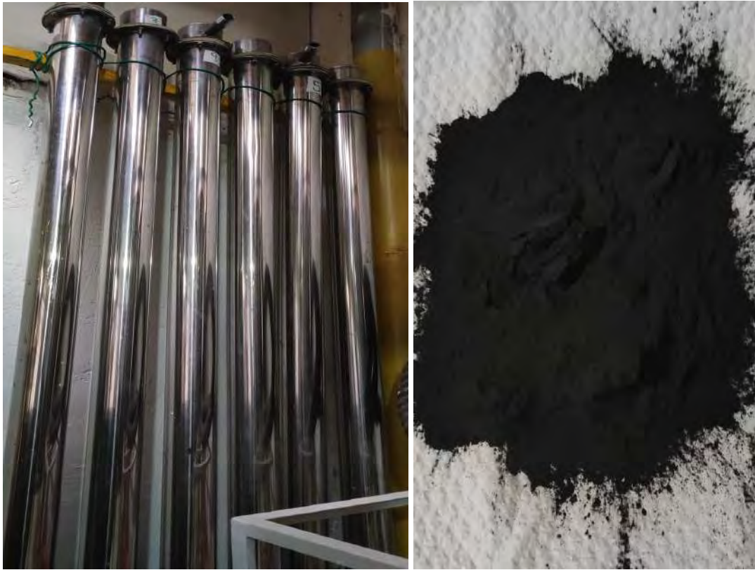
Figura 30: Columna de adsorción de lecho fijo y carbón activo vegetal
