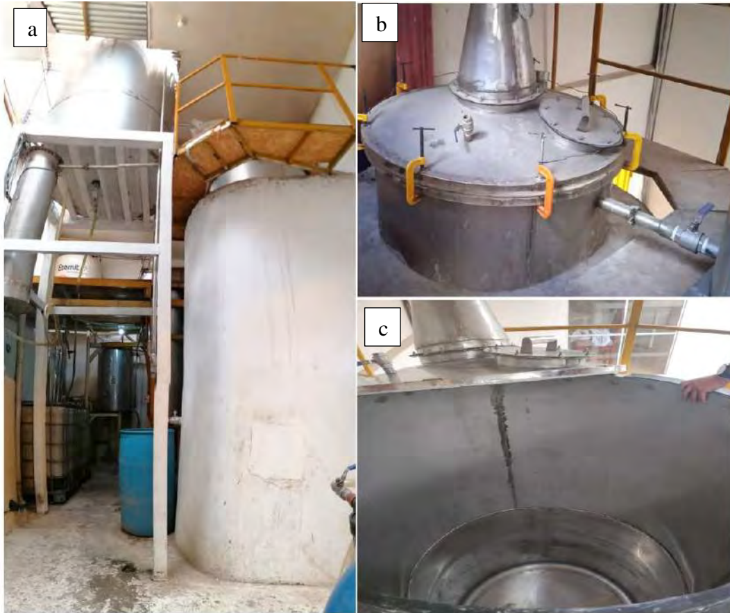
Figura 27: Equipo de destilador batch de 5000 litros, a) vista lateral, b) vista superior, c) vista de profundidad
