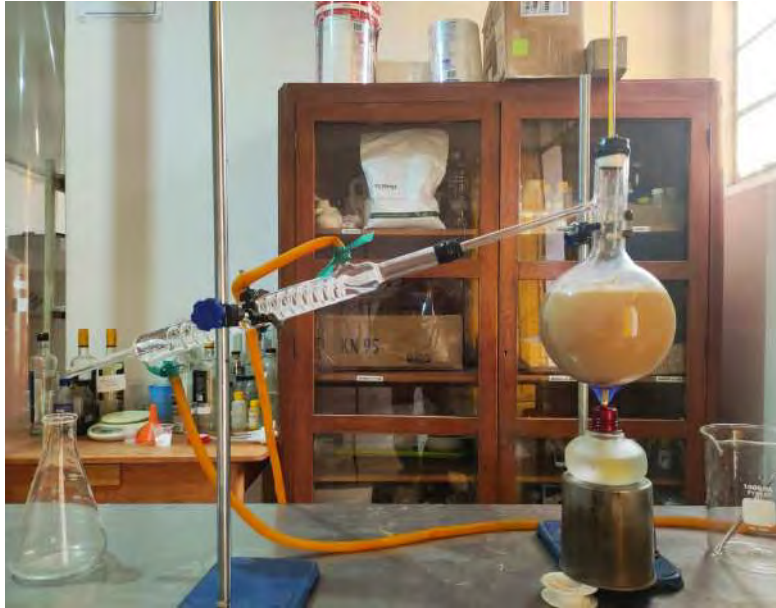
Figura 23: Equipo de destilación con el residuo líquido
