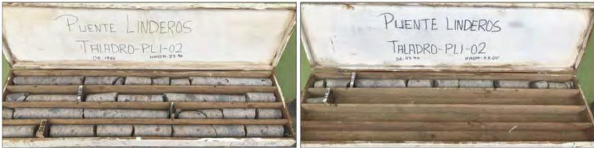
Fotografía 46. Testigos de perforación 02 del puente linderos proyectado.
