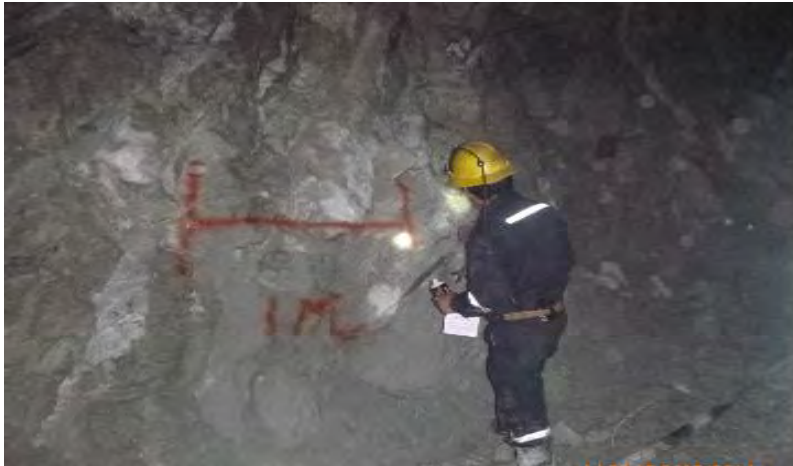
Figura 22 Marcado del hastial de 1 metro lineal
