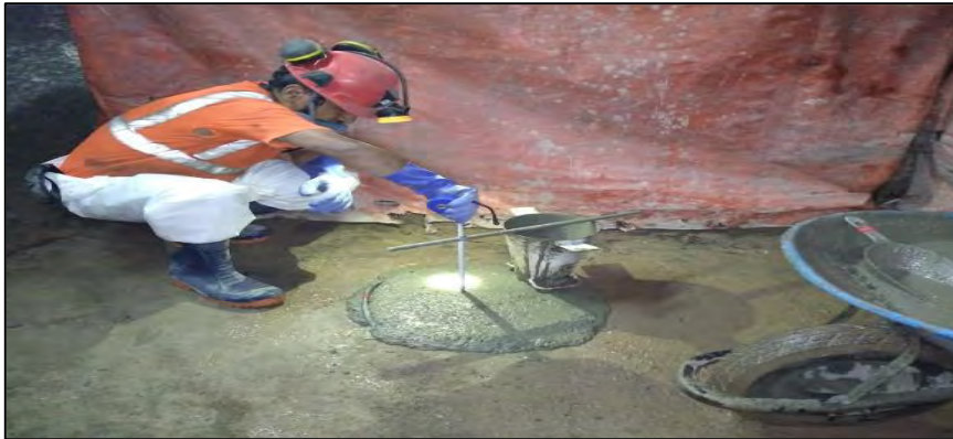
Figura 45 Prueba de slump con fibras metálicas.
