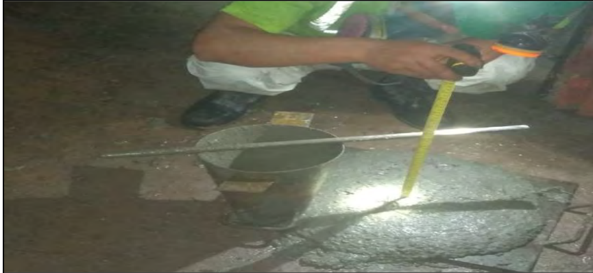
Figura 44 Prueba de slump con fibras sintéticas
