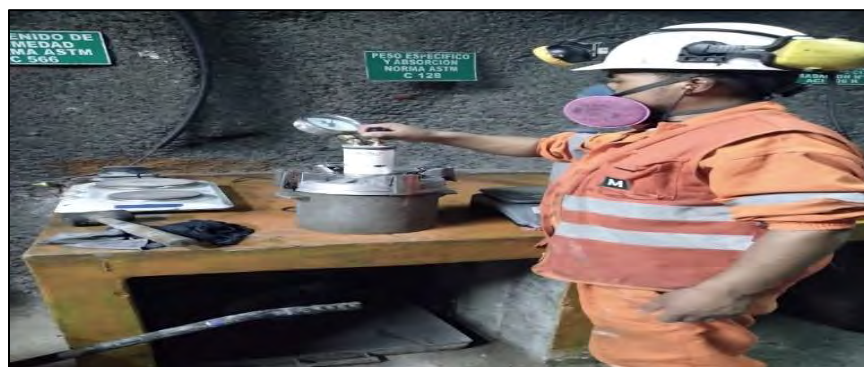
Figura 46 Ensayo del peso unitario del shotcrete
