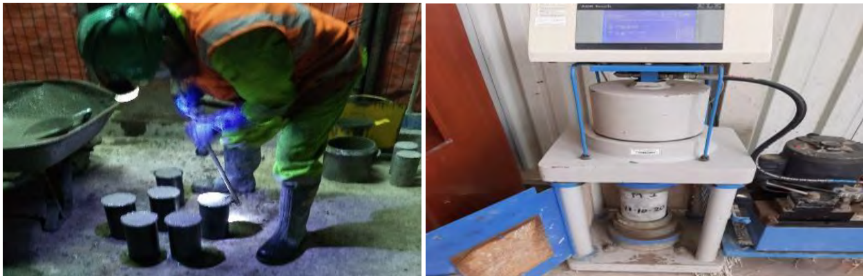
Figura 52 Preparación de núcleos para ensayo de shotcrete endurecido.
