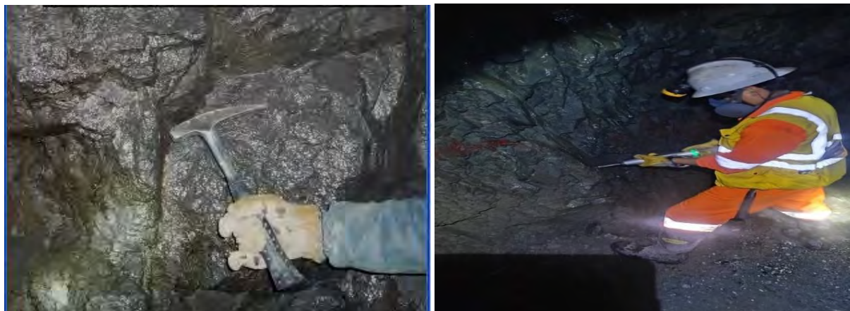
Figura 24 Mapeo del macizo rocoso en Rp 565 sw Nv. 23.
