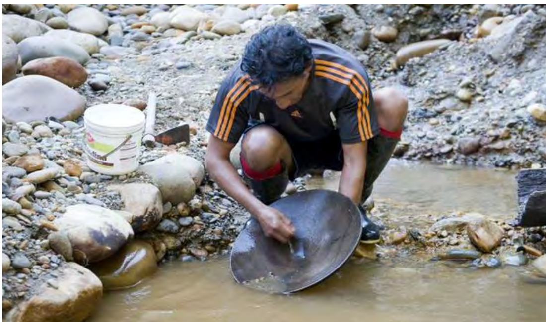
Imagen 27: Último proceso de recuperación del mineral precioso listo para el quemado o refogue.
