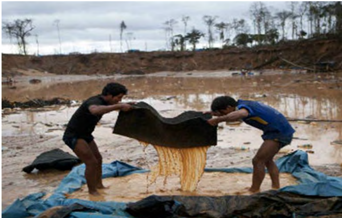
Imagen 25: Proceso de lavado y sacudimiento de las alfombras para obtener la arenilla negra y el metal precioso dentro de Concesión Aurífera Linda Dos
