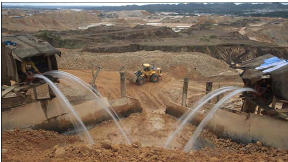
Imagen 5: Explotación combinada con maquinaria y chute Delta 1
