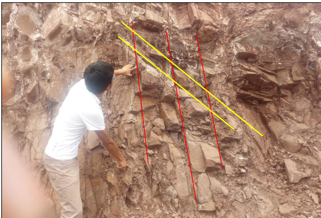
Fotografía 18. Caída de rocas en el corte de carretera APV Qapaqñan.
