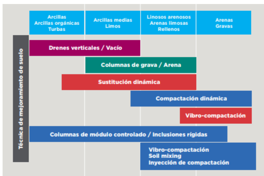
Figura 20. Técnicas de mejoramiento de suelos
