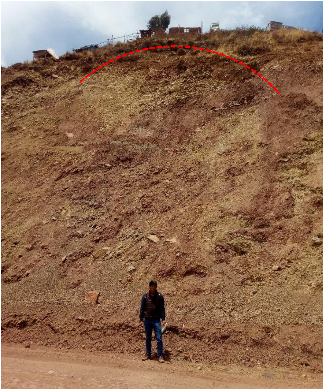
Fotografía 16. Presencia de una corona de deslizamiento rotacional delimitado en la APV Hatunwasi.
