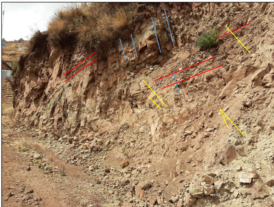
Fotografía 6. Rocas muy fracturadas del Fm. Puquín (se observan 3 familias de discontinuidades) ubicadas en la APV San Bernardo.
