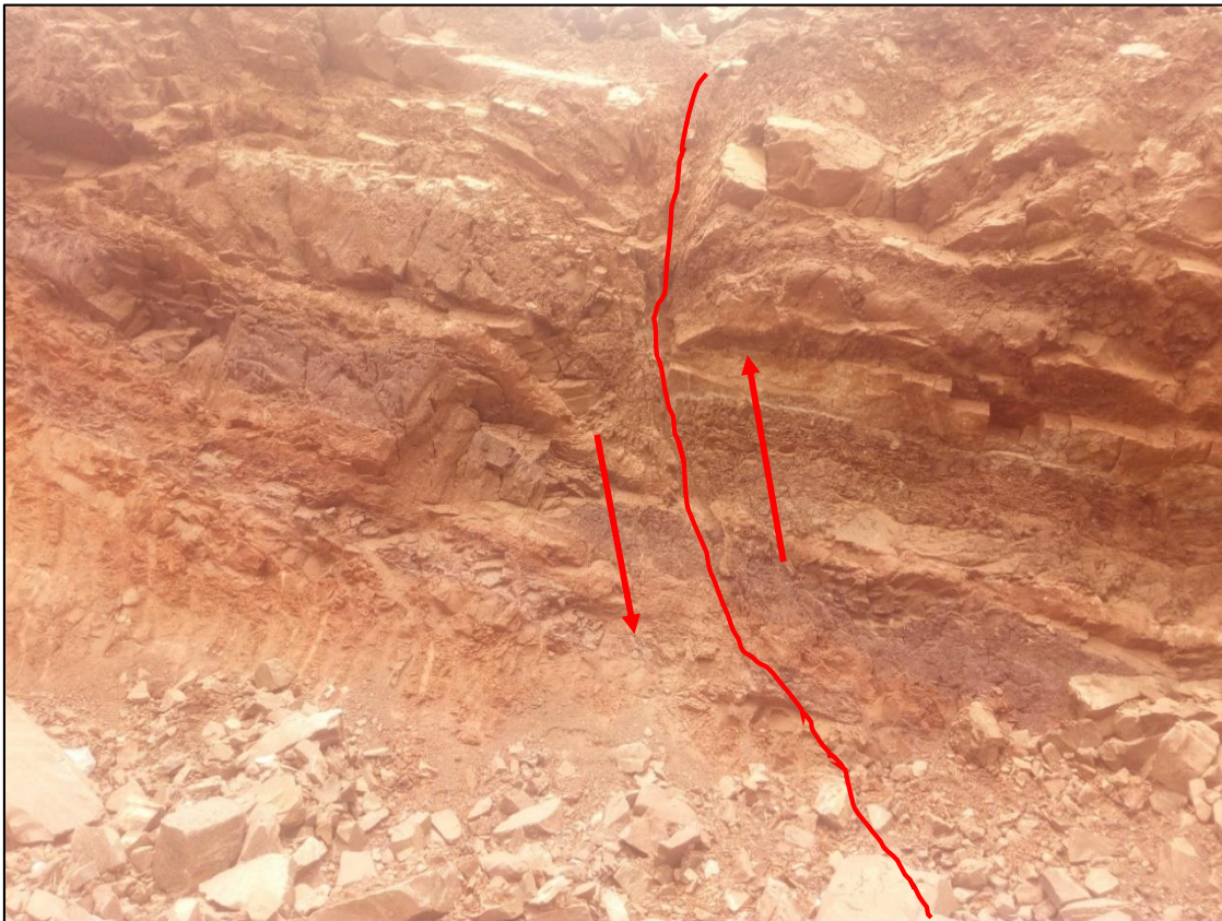
Fotografía 8. Presencia de falla inversa en el corte de carretera APV Kapañan.
