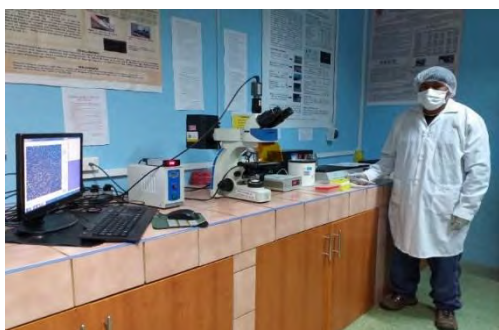
Figura 5. Microscopio de contraste de fases - fluorescencia, platina térmica, videocámara y computadora ejecutando el programa ISAS v.1.2.
