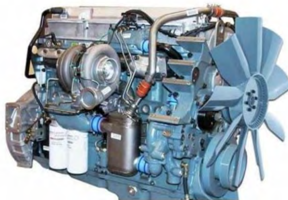
Fotografía N° 1 Motor Diésel Detroit Series 60
