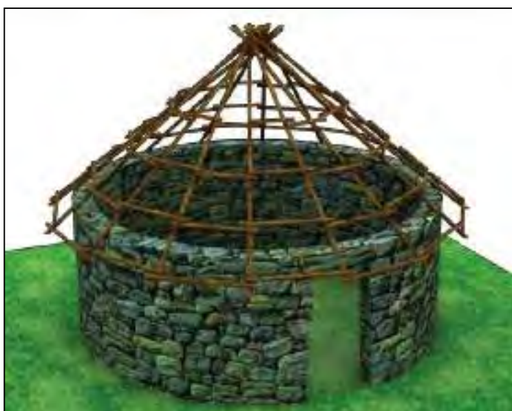
Imagen 39. Cubierta tipo choza, sin columna central. Fuente: Qhapaq Ñan
