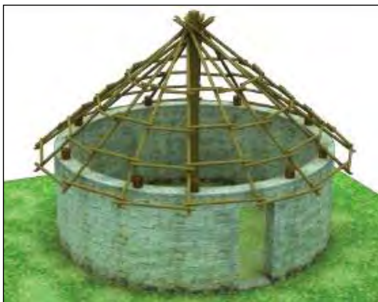
Imagen 40. Cubierta tipo choza, con columna central. Fuente: Qhapaq Ñan.
