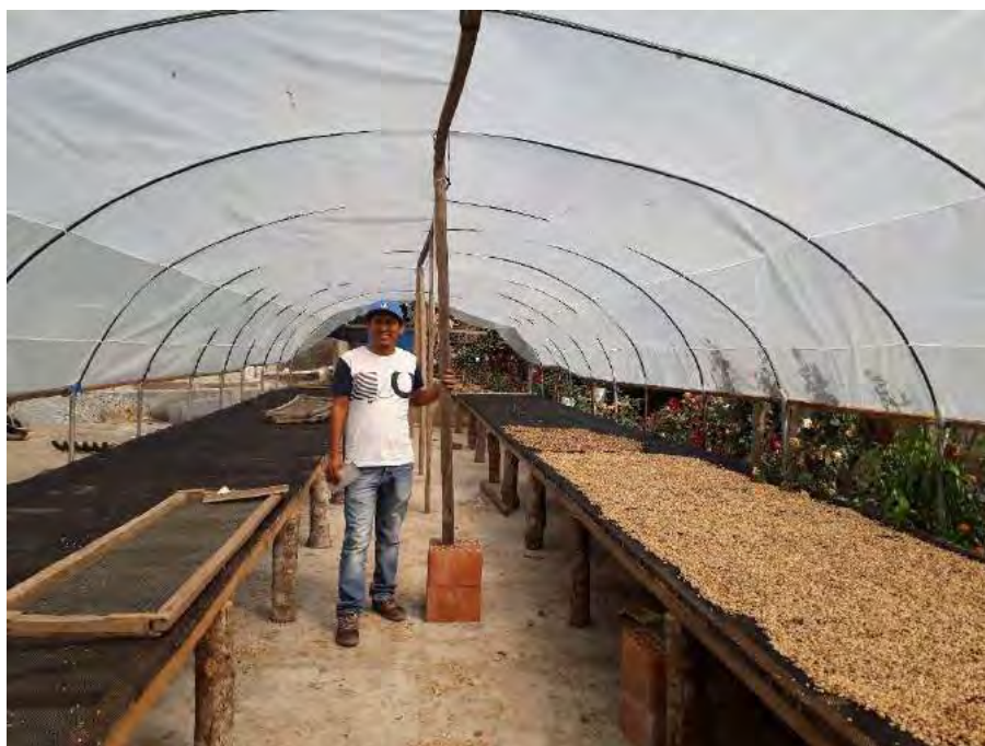
FOTO 01: Secadero solar de café, instalado con PROCOMPITE, sector de San Miguel - Distrito de Quellouno, La Convención - Cusco
