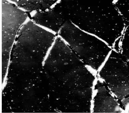
Figura 21: Fibra de yute vista a través de un microscopio óptico (Collings & Milner, 1978)
