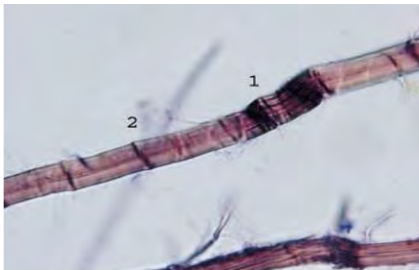
Figura 16: Imagen de las fibras de papel a través de un microscopio óptico. Se observa 1) nudos y 2) crucetas a lo largo de la fibra (García et al., 2004).
