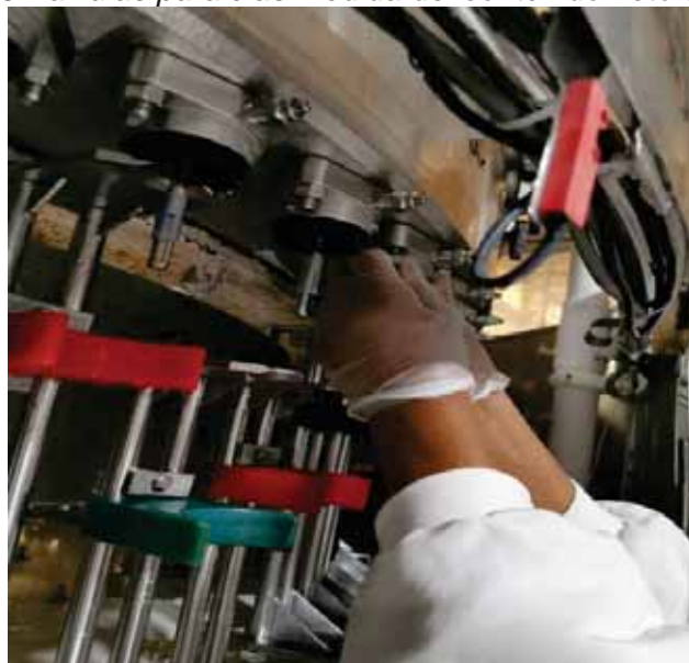
Figura 15 Válvulas paralelas medida del contenido neto del producto final
