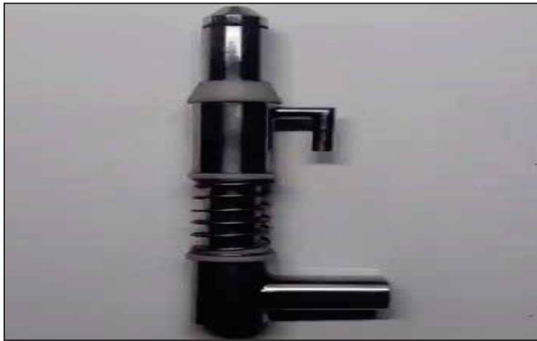
Figura 14 Válvula de medición del contenido neto del producto final embotellado
