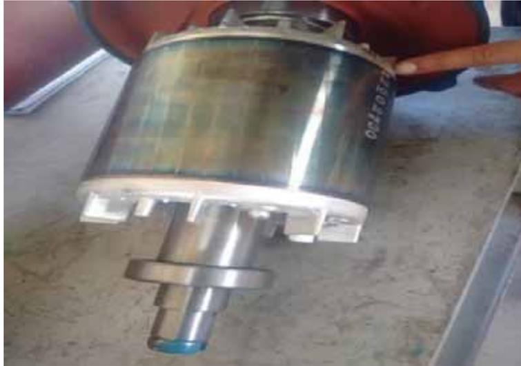
Figura 19. Rotor del Motor de Inducción Jaula de Ardilla
