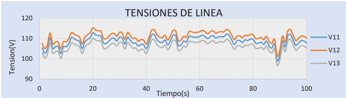
Figura 95. Tensiones de línea con carga máxima.
