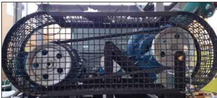
*Figura 80. Acoplamiento del MAG por correa.*
