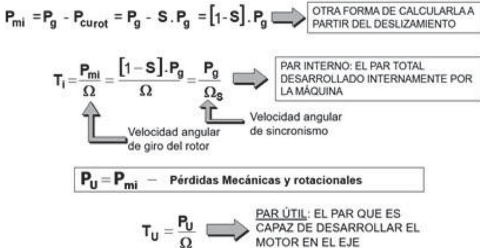
Figura 23. Fórmulas de las potencias, torques y pérdidas del motor
