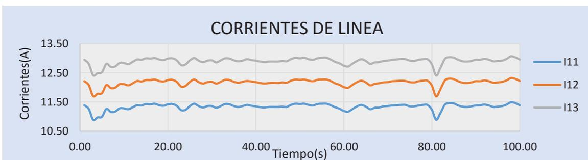
Figura 103. Corrientes de línea a velocidad media carga constante.
