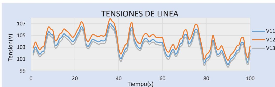
Figura 108. Tensiones de línea a caudal mínima carga constante.
