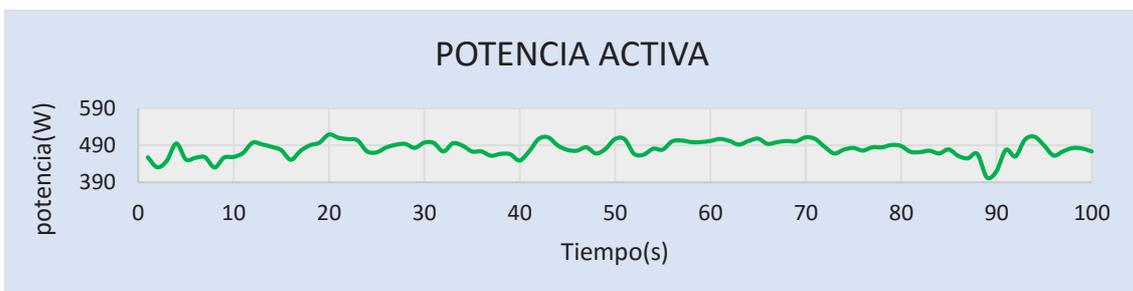
Figura 97. Potencia Activa con cargas máximas
