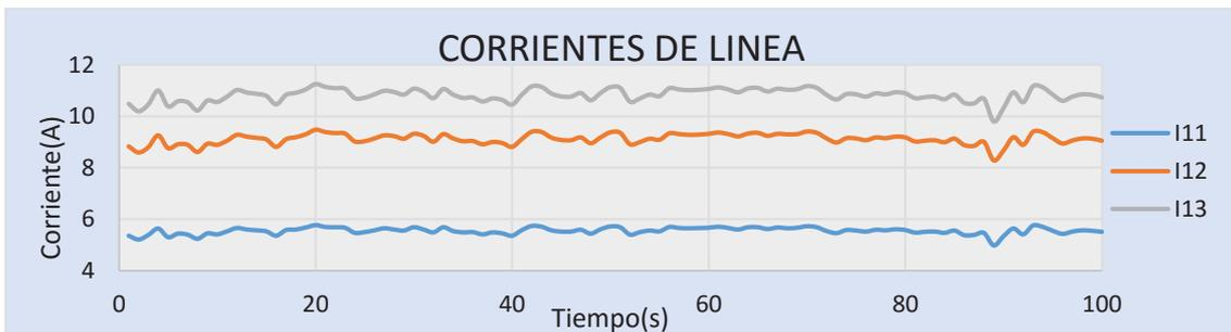
Figura 96. Corrientes de línea a carga máxima
