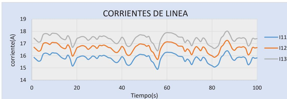
Figura 88. Corrientes de línea a carga mínima
