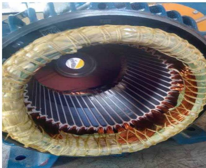
Figura 18. Estator del Motor de Inducción Jaula de Ardilla
