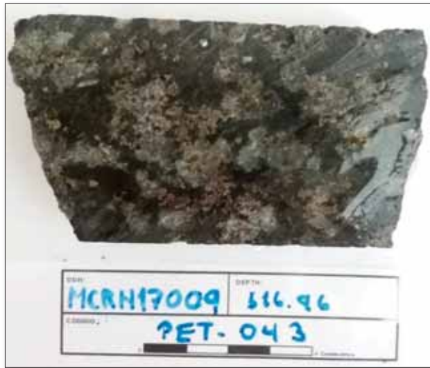
Foto N° 7: Muestra de la brecha polimíctica con biotita hidrotermal en la matriz correspondiente al sondaje DDHMCRH17009 a los 516.96 m.
