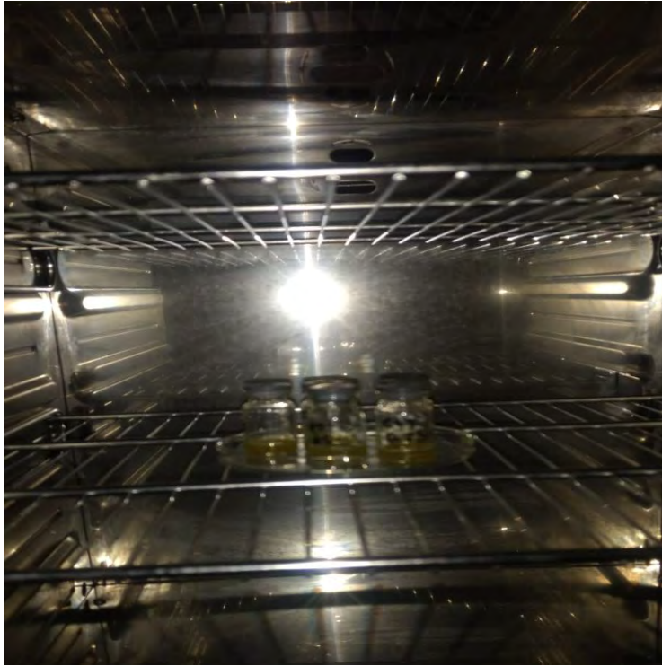
Fotografía N° 8: Estabilización del aceite de cañihua en la estufa a 65 °C
