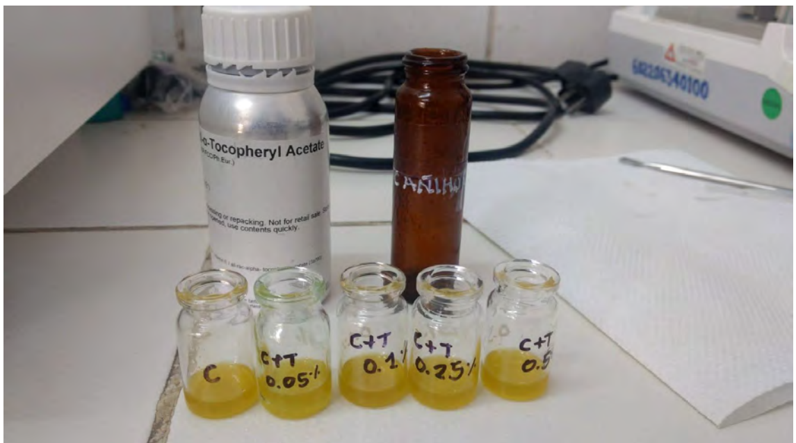
Fotografía N° 7: Estabilización del aceite de cañihua con alfa tocoferol.
