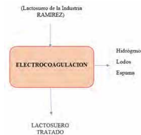
Figura 15. Diagrama del flujo del proceso de electrocoagulación
