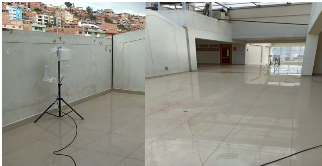
Figura 4.23: Lugar de pruebas, distancia entre transmisor y receptor d = 14 m para el envío de información de datos de bit aleatorio.
