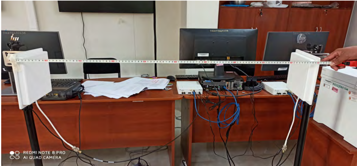
Figura 3.2: Distancia entre antena transmisora y receptora d = 1\text{ m} del sistema de comunicación.
