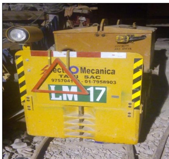
Figura 24. Locomotora de 1.5 Tn.
