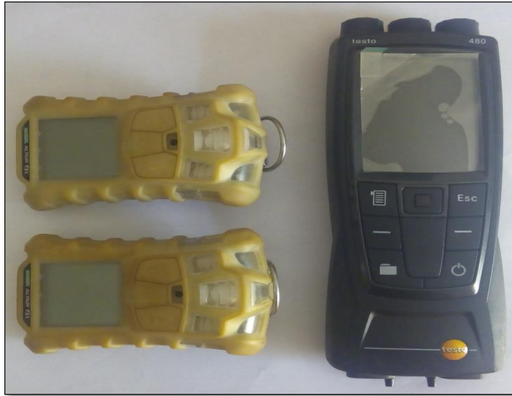
Figura 33. Instrumentos de medición de ventilación.
