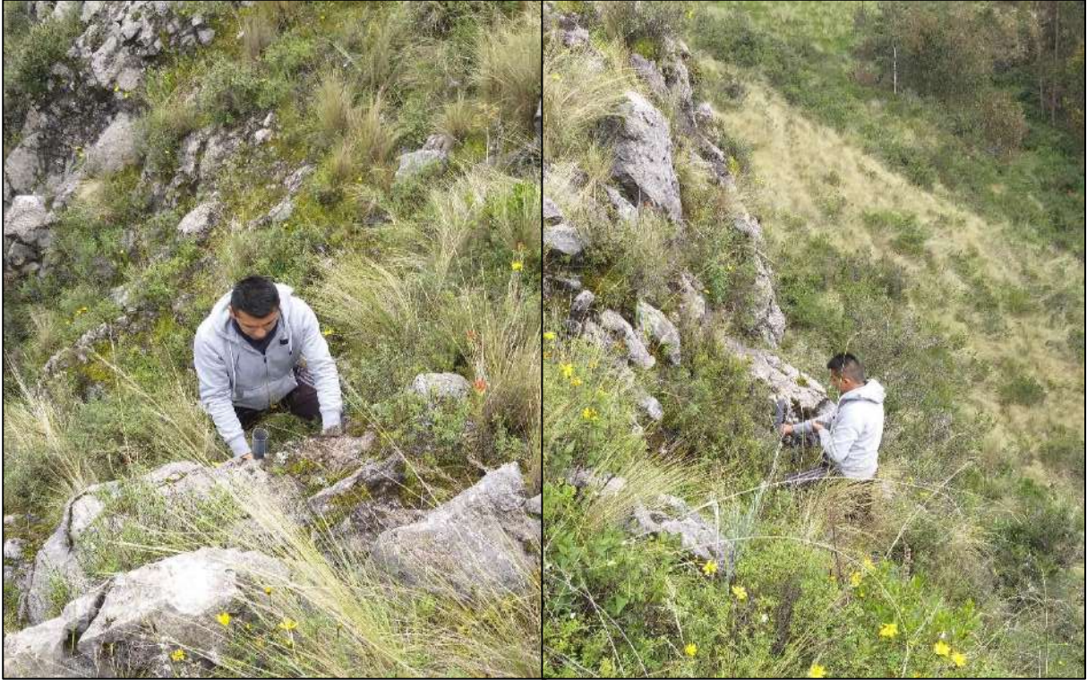
FOTOGRAFÍA 61: PRUEBA DE PERMEABILIDAD EN EL MACIZO ROCOSO DE LA FORMACION ARCURQUINA.
