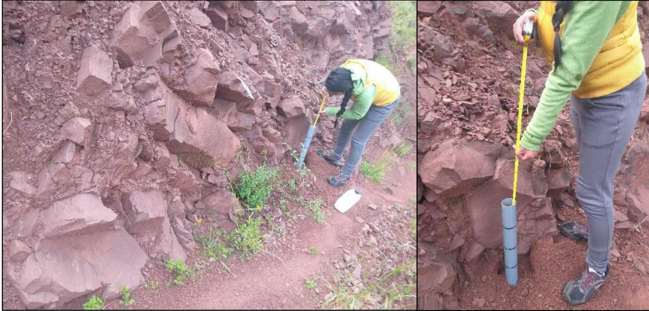
FOTOGRAFÍA 63: PRUEBA DE PERMEABILIDAD EN EL MACIZO ROCOSO DEL GRUPO MITU.
