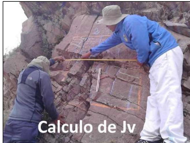
FOTOGRAFÍA 39: MEDIDAS PARA EL CALCULO DEL RQD.
