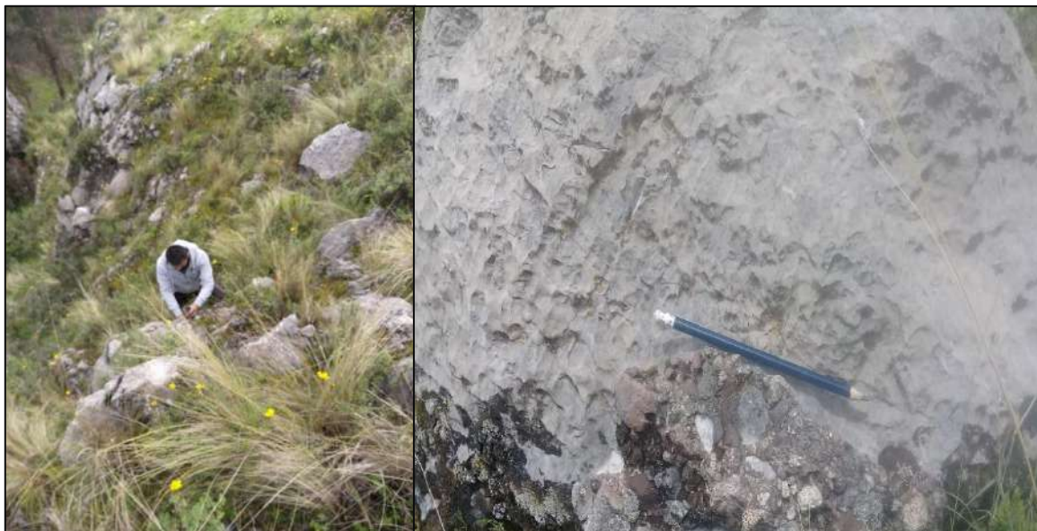
FOTOGRAFÍA 25: AFLORAMIENTO DE CALIZAS DE LA FORMACIÓN ARCURQUINA DE COLOR GRIS, CON VESTIGIOS DE ESTRUCTURAS POR DISOLUCIÓN.
