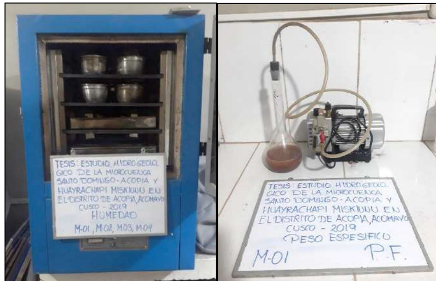
FOTOGRAFÍA 59: ENSAYOS DE HUMEDAD Y PESO ESPECÍFICO DE LAS MUESTRAS DE SUELOS TOMADAS EN CAMPO.
