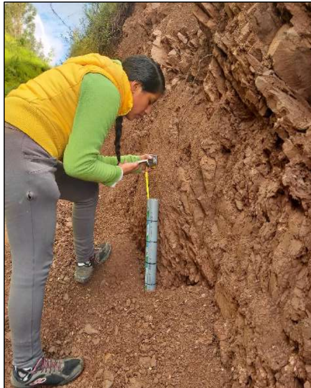
FOTOGRAFÍA 62: PRUEBA DE PERMEABILIDAD EN EL MACIZO ROCOSO DE LA FORMACION ANTA (ARENISCAS FRACTURADAS).
