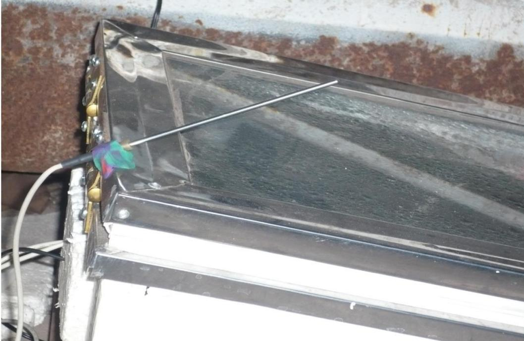
**Foto N°3: Vista del sensor del Multilog Pro instalado en el prototipo para medir la temperatura exterior de la cubierta del vidrio del sensor del Multilog Pro instalado**
