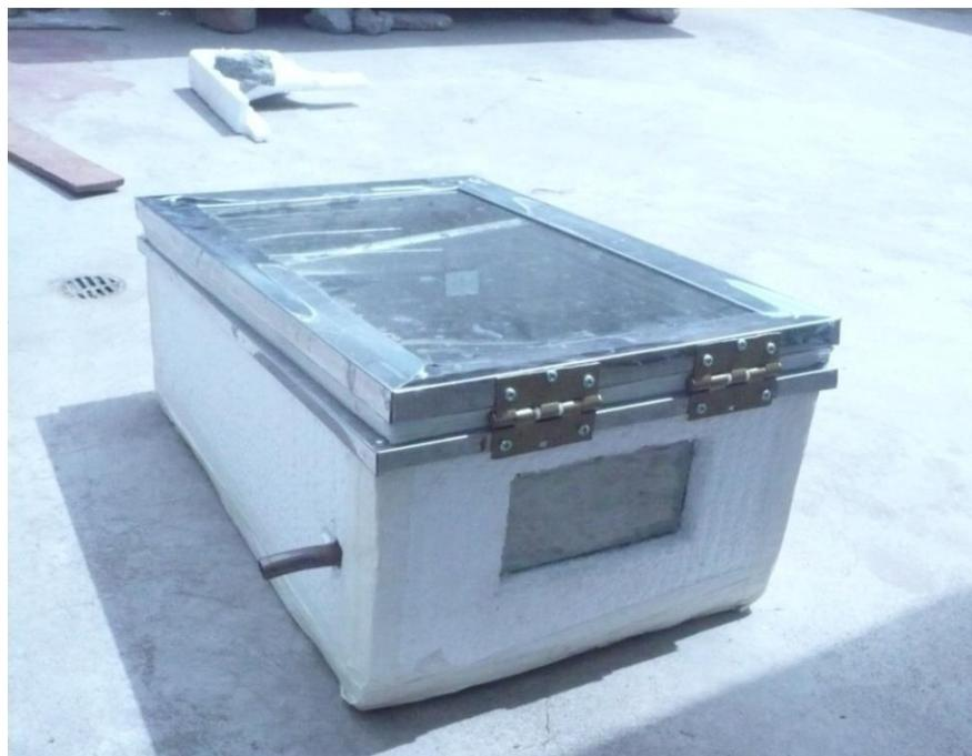
Foto N°1: Vista del Prototipo de destilador solar construido.
