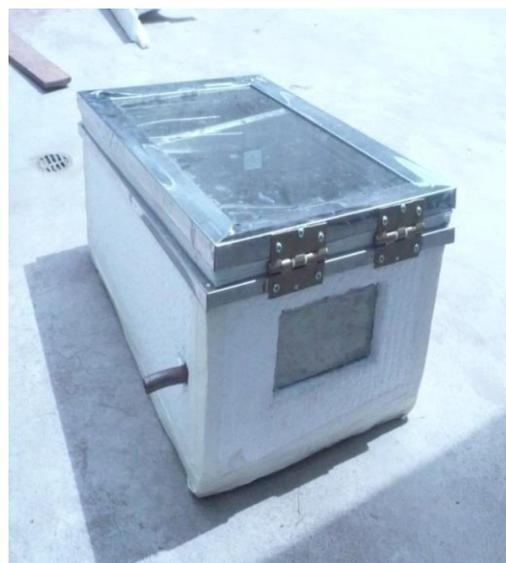
figura: 4.2 Prototipo del destilador solar construido
