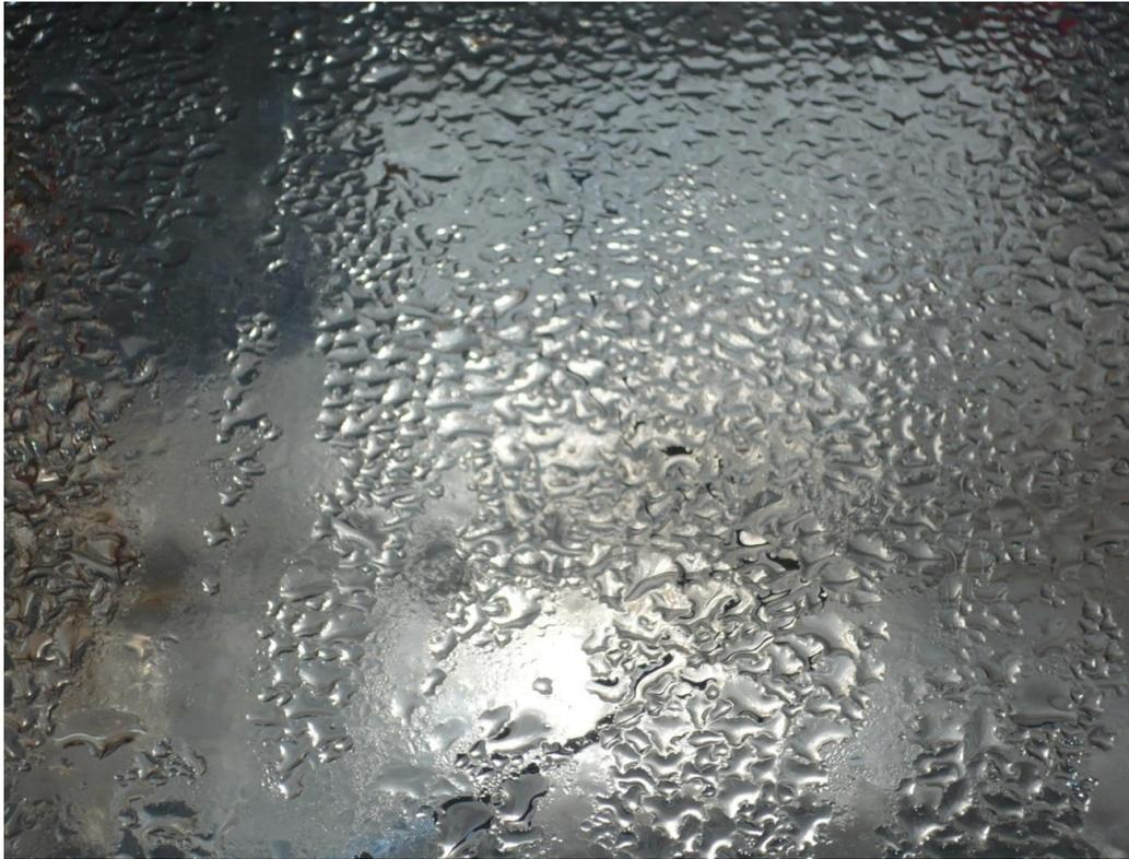
Foto N°4: Formación de gotas de agua por efecto de la condensación y deslizamiento por la superficie interna del vidrio hacia el canal de recolección.
