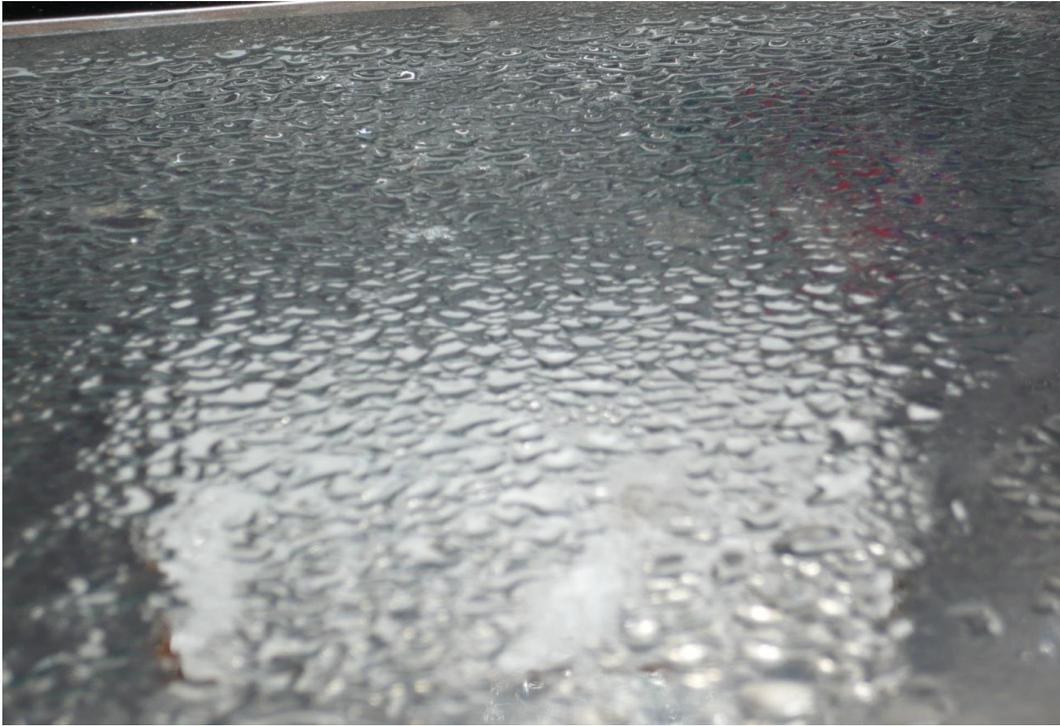
Foto N°4: Vista de las gotas de agua condensada en la cubierta de vidrio del prototipo del destilador solar.
