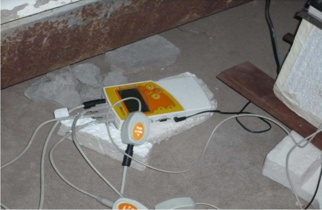
Foto N° 2: Vista del MultiLog Pro instalado con los sensores de conductividad y temperaturas en el sistema de destilador solar.
