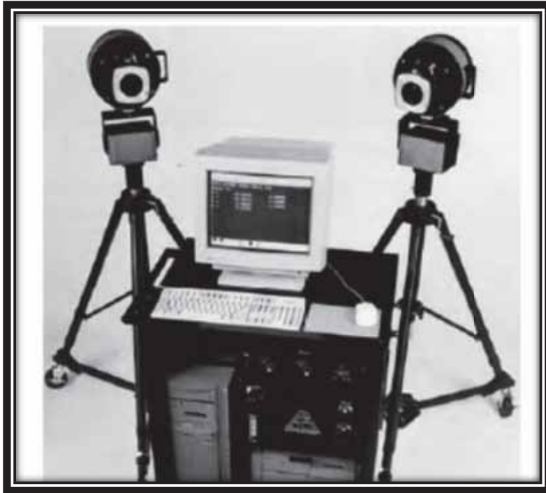
Figura 12. Medición fotogramétrica digital (Fuente; Luhmann T, 2011)
