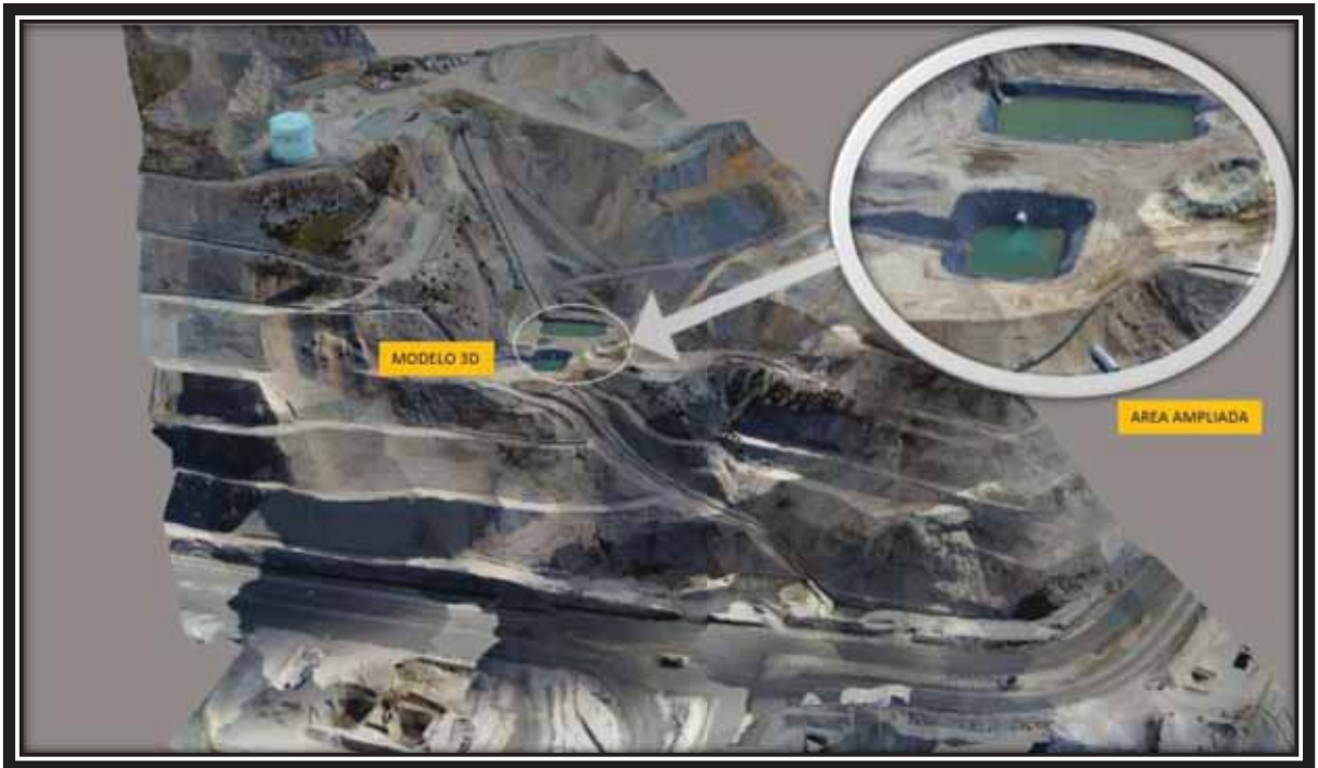
Figura 43. Modelo 3d con extensión .3mx con detalle en poza (Fuente; elaboración propia).
