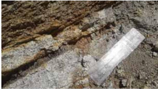
Foto N° 23: Veta de Cuarzo con textura crustiforme con Oxidos de Hierro ( $FeO$ ), con un halo de alteracion argilica (arcillas). FUENTE: Propia.
