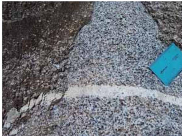
Foto N° 14: Tonalita con Textura Poikilítica equigranular de grano grueso. (N: 8418760, E: 814868, h: 3671m).
