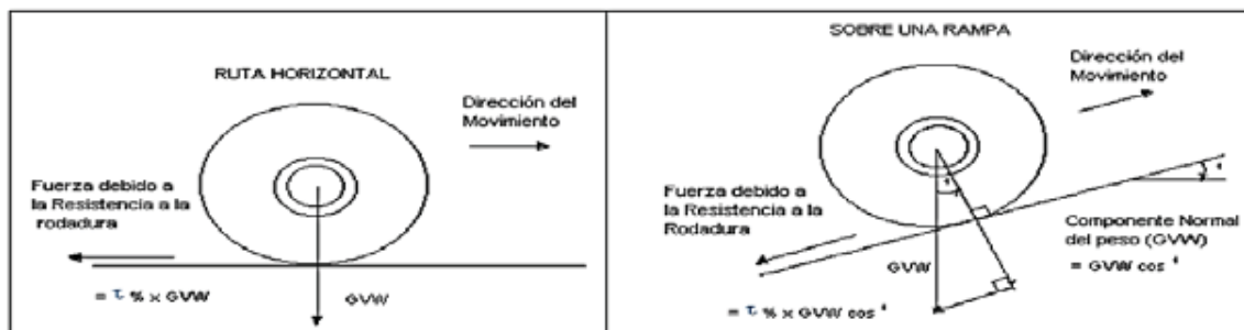
Figura 2.5: Coeficiente de rodadura según la pendiente.
