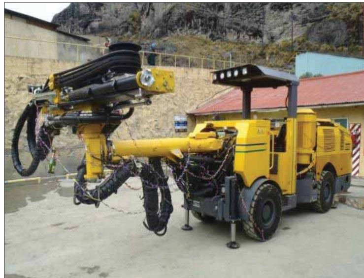
Figura 3.14: Equipo de Perforación Boomer T1D
