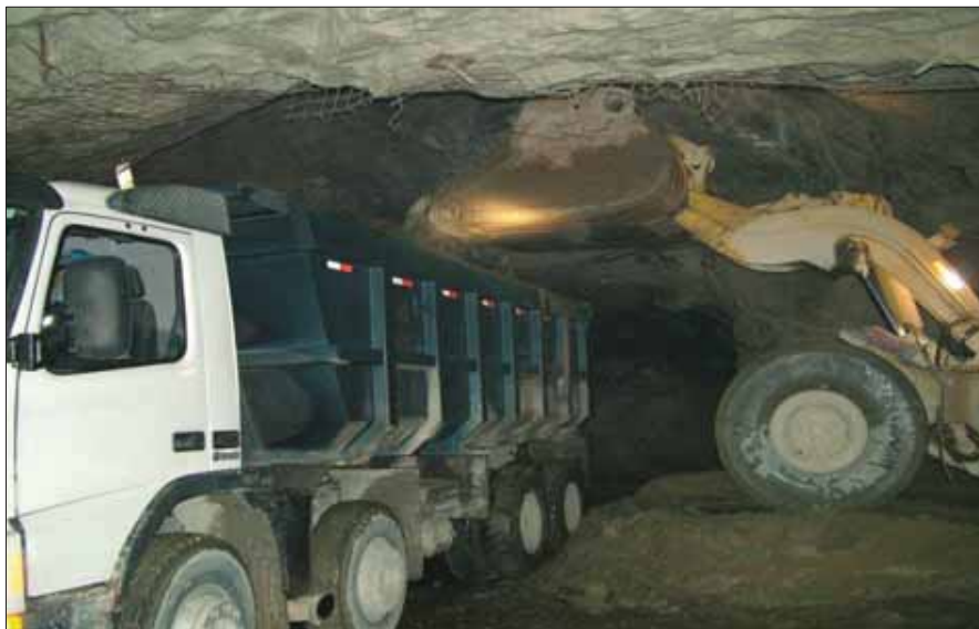
Figura 3.20: Sistema de alimentación por el Scooptram a los Volquetes FMX
