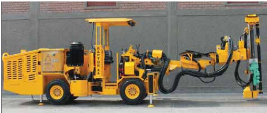
Figura 3.16: Equipo de Perforación Raptor 44 XP
