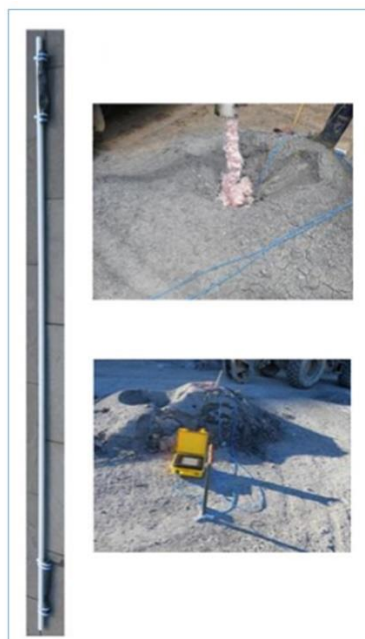
Figura 4.4: Equipo para medir la densidad real de carga dentro del taladro
