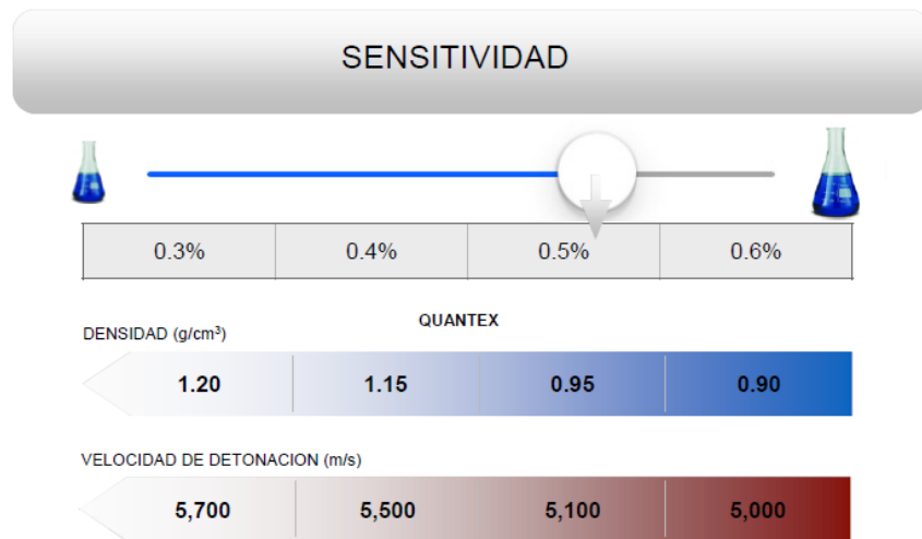
Figura 4.7: Selección del porcentaje de sensibilizante para el tipo de roca adecuado
