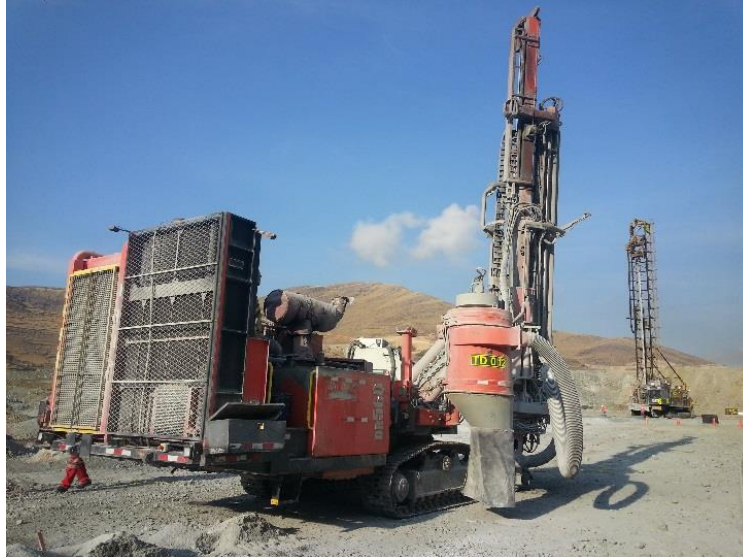
Figura 3.9: Perforadora para Pre- Corte Sandvik DR560 en el Tajo Ferrobamba - Las Bambas
