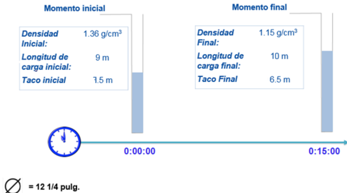
Figura 4.3: Tiempo de Gasificación dentro del taladro
