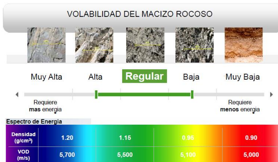
Figura 4.10: Volabilidad del Macizo rocoso para la selección del porcentaje de sensibilizante.
