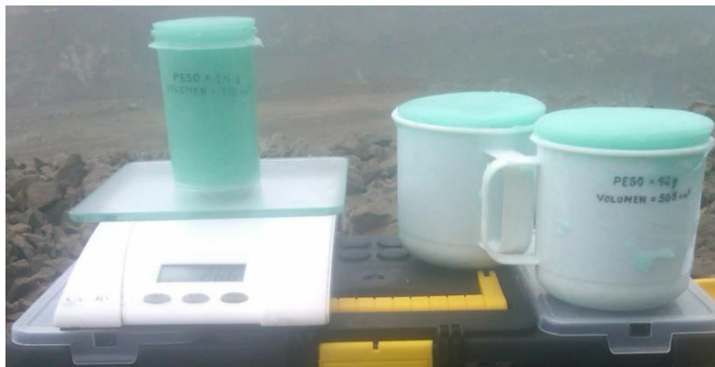
Figura 4.8: Medición de Densidades en Campo
