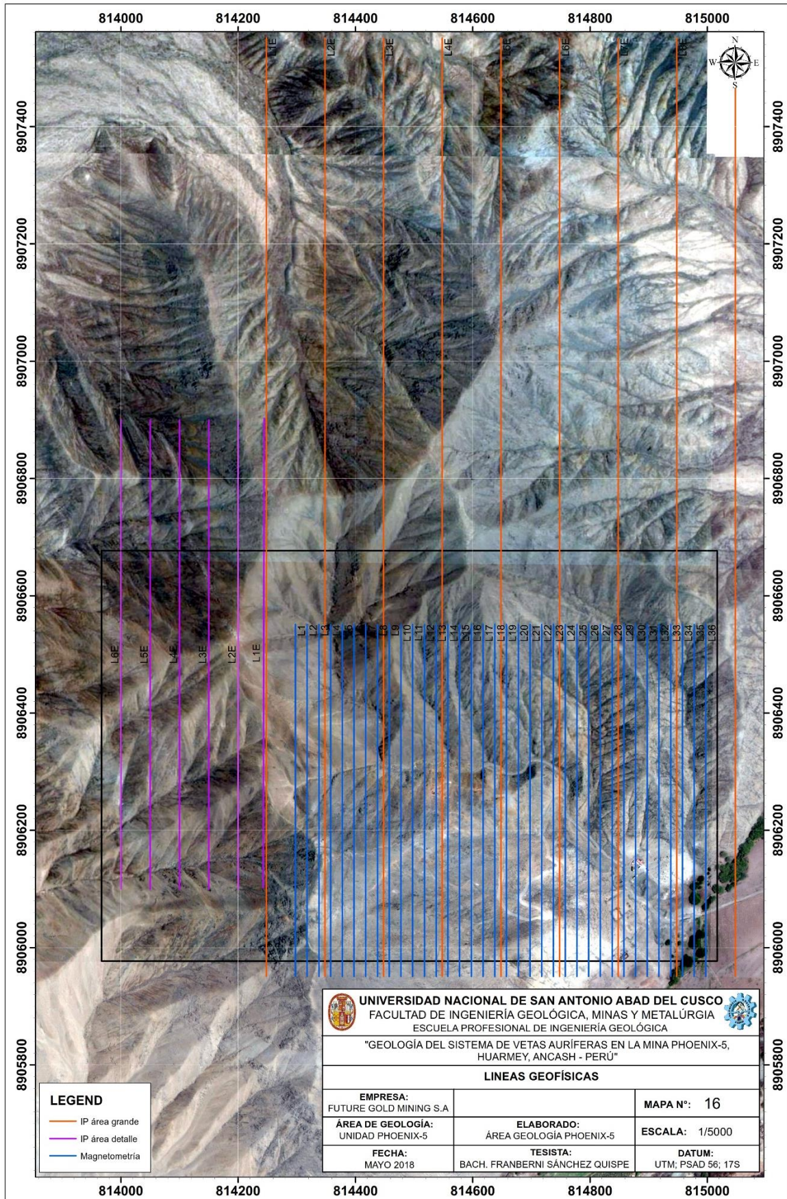
Mapa 16: Mapa de las líneas geofísicas: Magnetometría, IP área grande e IP área detalle.
