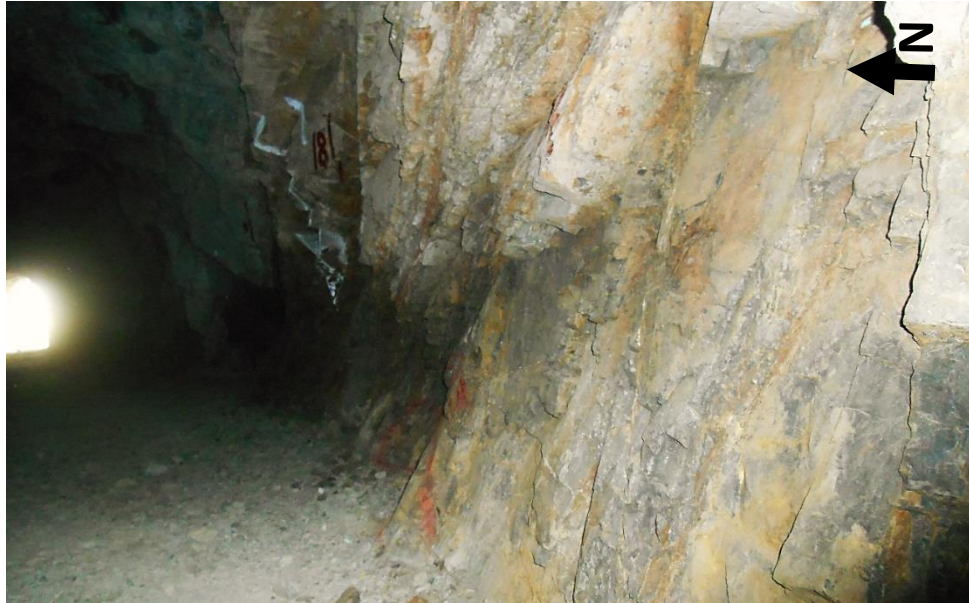
Foto 39: Interior mina, NV-230, se observa la falla San Cipriano presentando un sistema de juntas paralelo a la estructura principal hacia su piso, con relleno de calcita, óxidos de hierro y gouge. Roca caja andesita porfírica.
