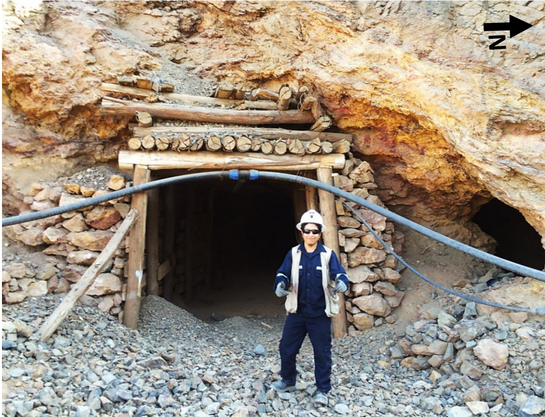
Foto 50: Bocamina del NV-279, veta-falla Virginia compuesta por limonitas, óxidos de manganeso, carbonatos de cobre y arcillas asociado a la actinolita. José Victorio está de escala.
