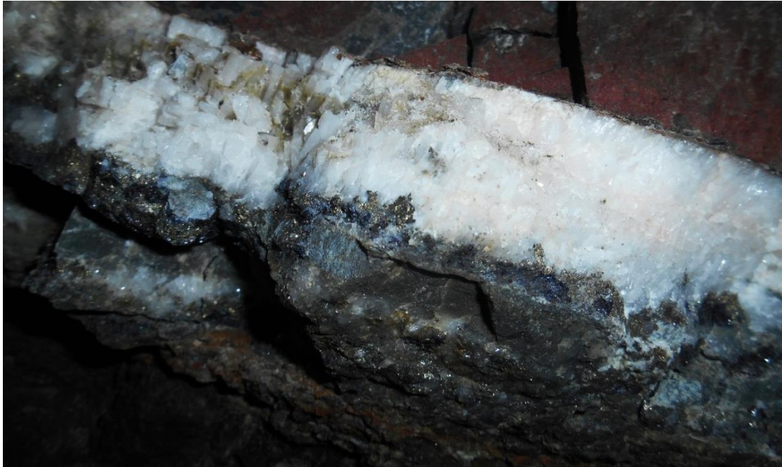
Foto 47: Interior mina, SN-243, falla San Jerónimo relleno con calcita 75% y pirita cúbica 20%.
