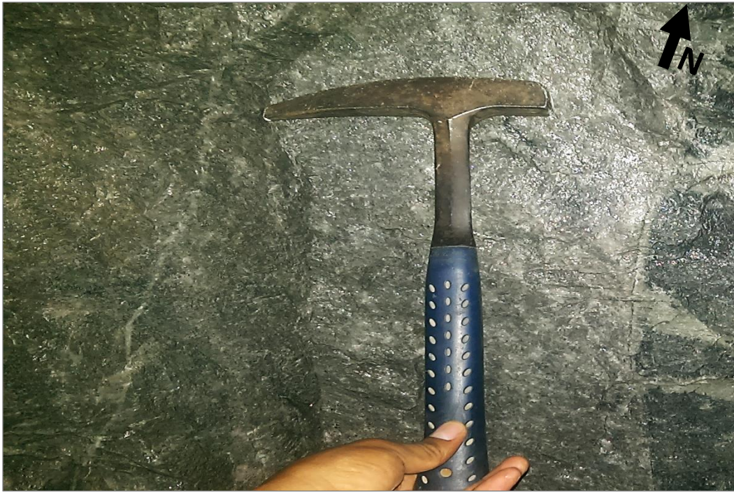
Foto 19: Interior mina, TJ- 409. Hornfels silicificado con venillas de cuarzo, sericita y pirita.
