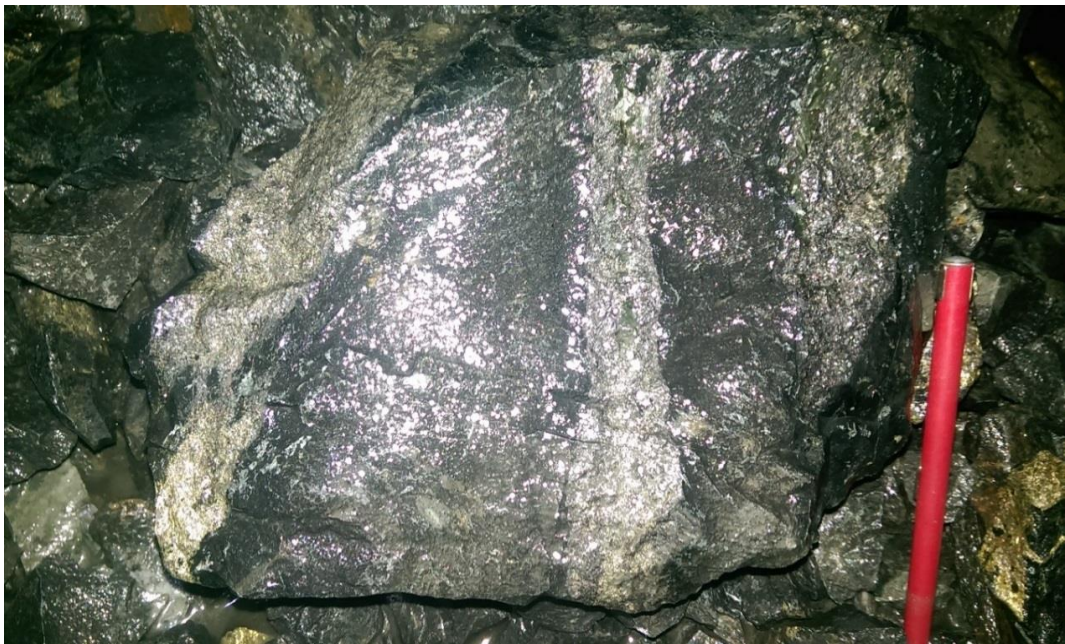
Foto 56: Interior mina, SN-243, veta Zulema, GA-357. Arsenopirita en venillas, de color negro gris pardo asociado con calcopirita y pirita.
