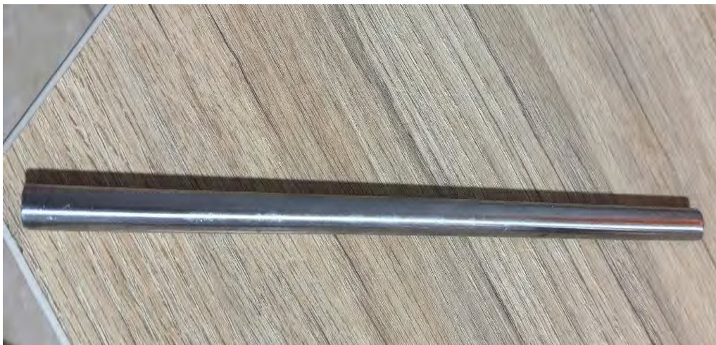
Cátodo de acero inoxidable AISI 304
