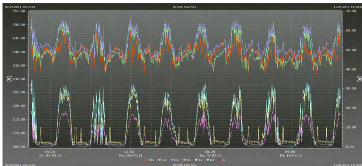
Tensión, corriente trifásica
