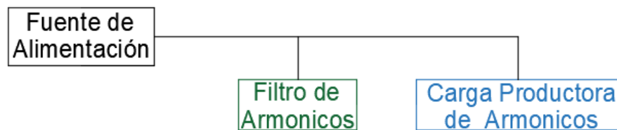
Figura 17: Filtro que desvía la corriente armónica entre la carga productora de armónicos y la fuente de alimentación
