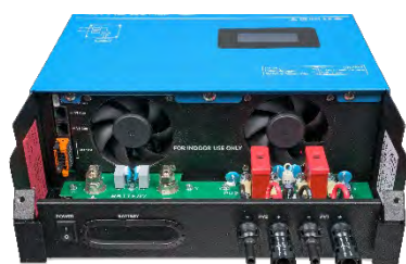
Interior del MPPT RS SmartSolar 450|100
