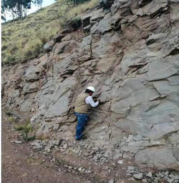
Figura 105: Medición con brújula Brunton
