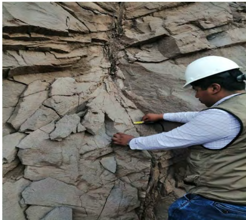
Figura 104: Medición e identificación de las características de discontinuidades
