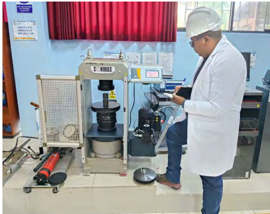
Figura 102: Ensayo de compresión uniaxial
