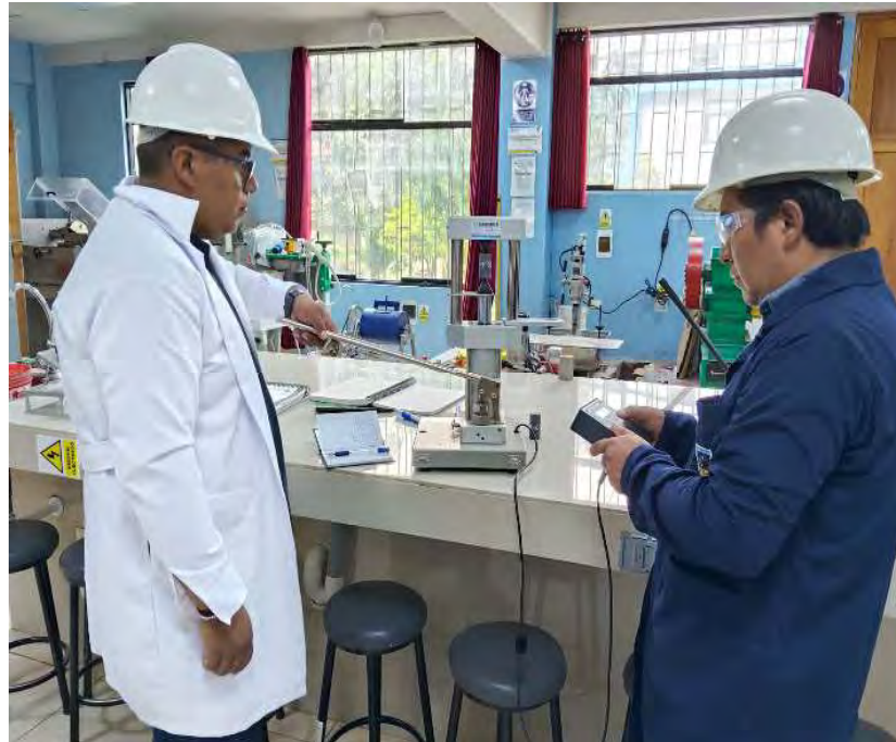
Figura 103: Ensayo de carga puntual
