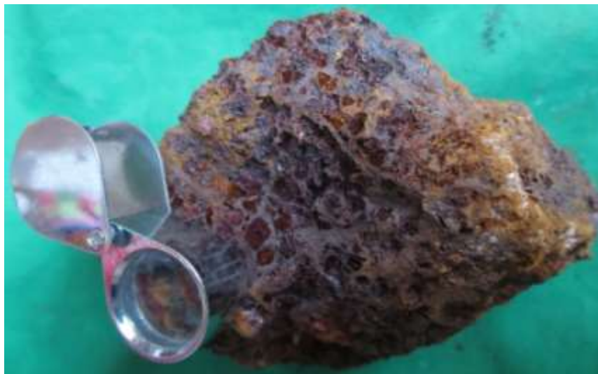
Foto N°30: Magnetita con textura brechoide
