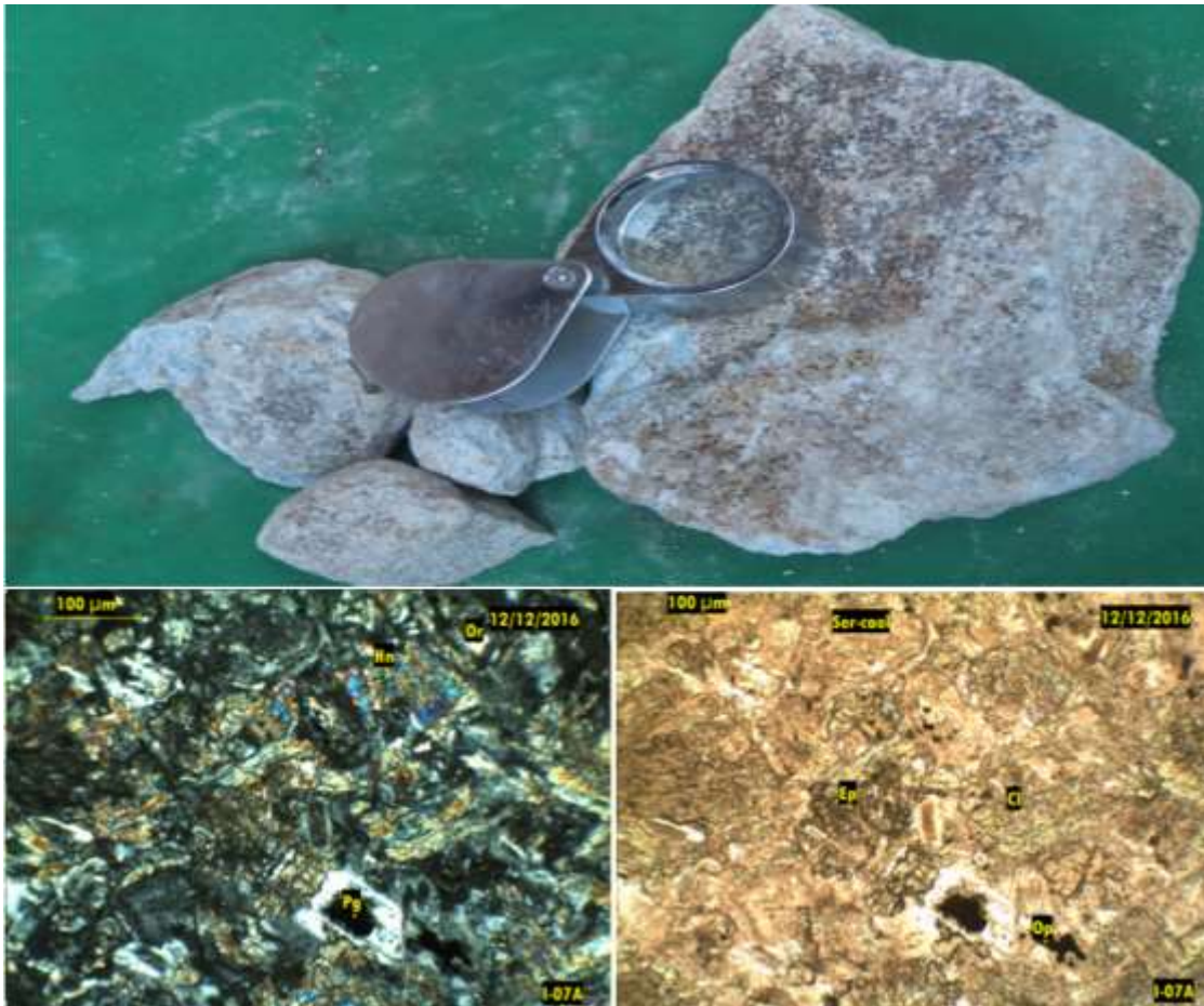
Foto N° 12: Cuarzo monzodiorita de Hornblenda. NC (Izquierda). Hornblenda (Hn) fuertemente alterada a clorita y plagioclasa (Pg) tabular moderadamente alterada a sericita-arcilla y ortoclasa (Or) anhedral e intersticial. NP (Derecha). Hornblenda fuertemente alterada a clorita (verde) y plagioclasa tabular moderadamente alterada a sericita-arcilla (rosado) y ortoclasa anhedral, fresca e intersticial. Epidota (Ep) verde amarillento en alto relieve.
