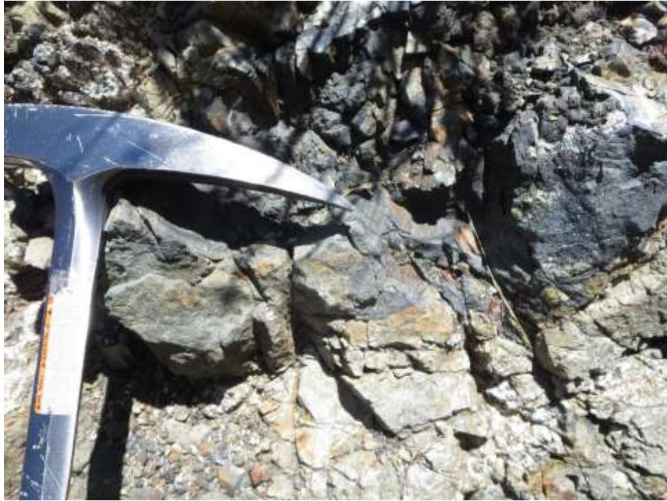
Foto N°26: Magnetita en contacto con el intrusivo monzodiorítico.
