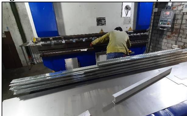
Figura 4-7 Procesos de doblado de los perfiles de la estructura metálica
