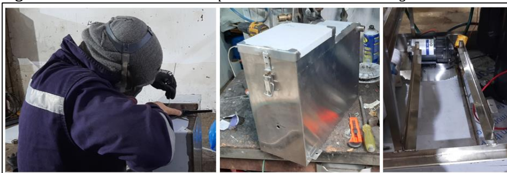
Figura 4-14 Fabricación del tanque de almacenamiento de agua
