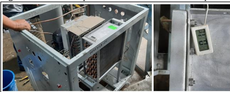
Figura 4-5 Primeras pruebas de rendimiento del evaporador
