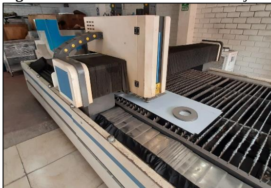
Figura 4-9 Procesos de corte de las rejillas de las coberturas mediante CNC laser
