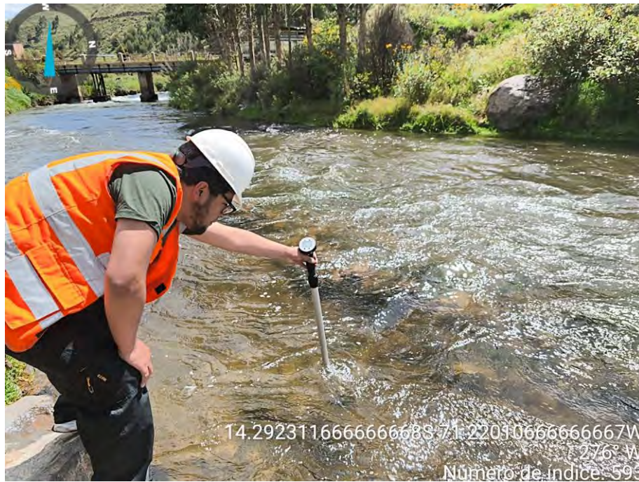
Anexo 122. Trabajo de campo, aforo de caudal con correntómetro en la subcuenca – Sallca
