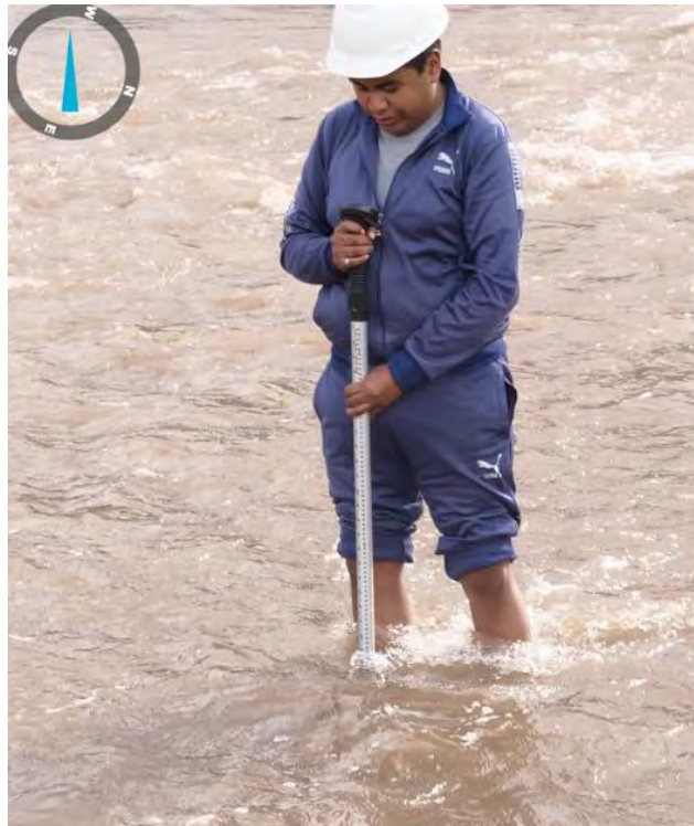
Anexo 131. Trabajo de campo, medición de la velocidad de caudal con correntómetro en la subcuenca – Huatanay
