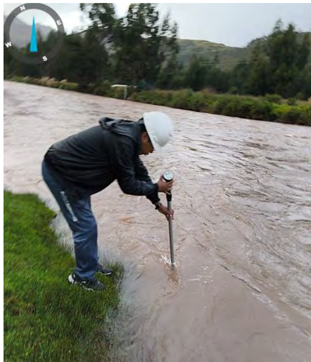
Anexo 137. Trabajo de campo, medición de la velocidad de caudal con correntómetro en la subcuenca – Machu Picchu
