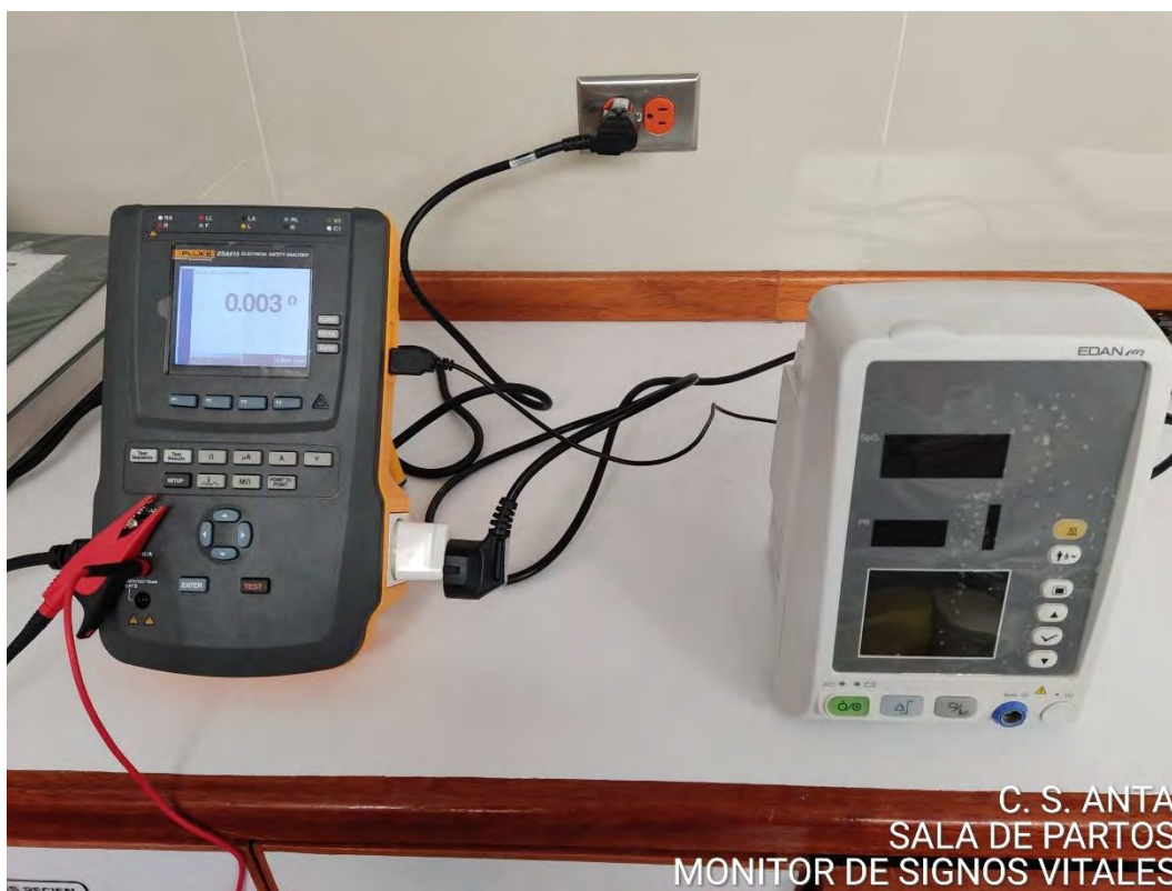
Figura 2 Conexión del analizador de riesgo eléctrico ESA615 de Fluke Biomedical a un equipo biomédico.
