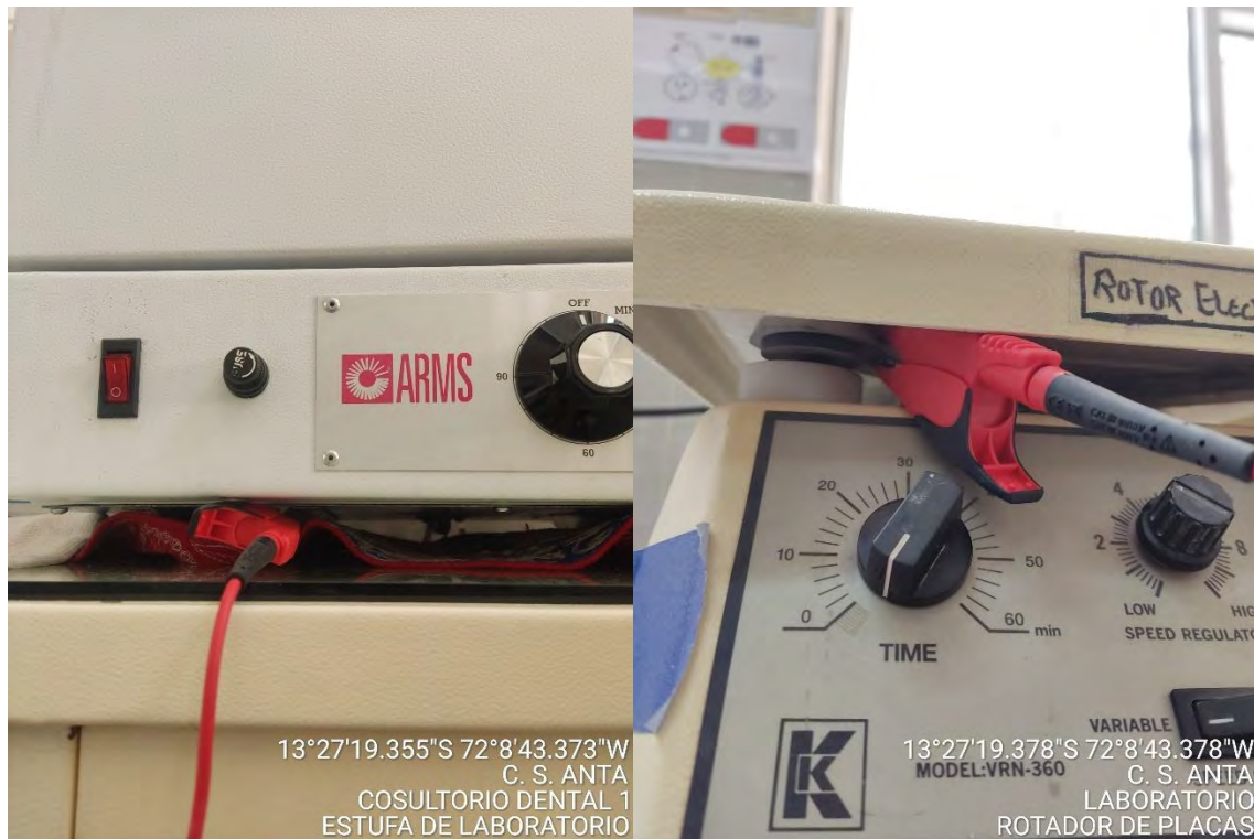
Figura 4 Conexión de la pinza de prueba de color rojo al punto metálico del equipo biomédico.
