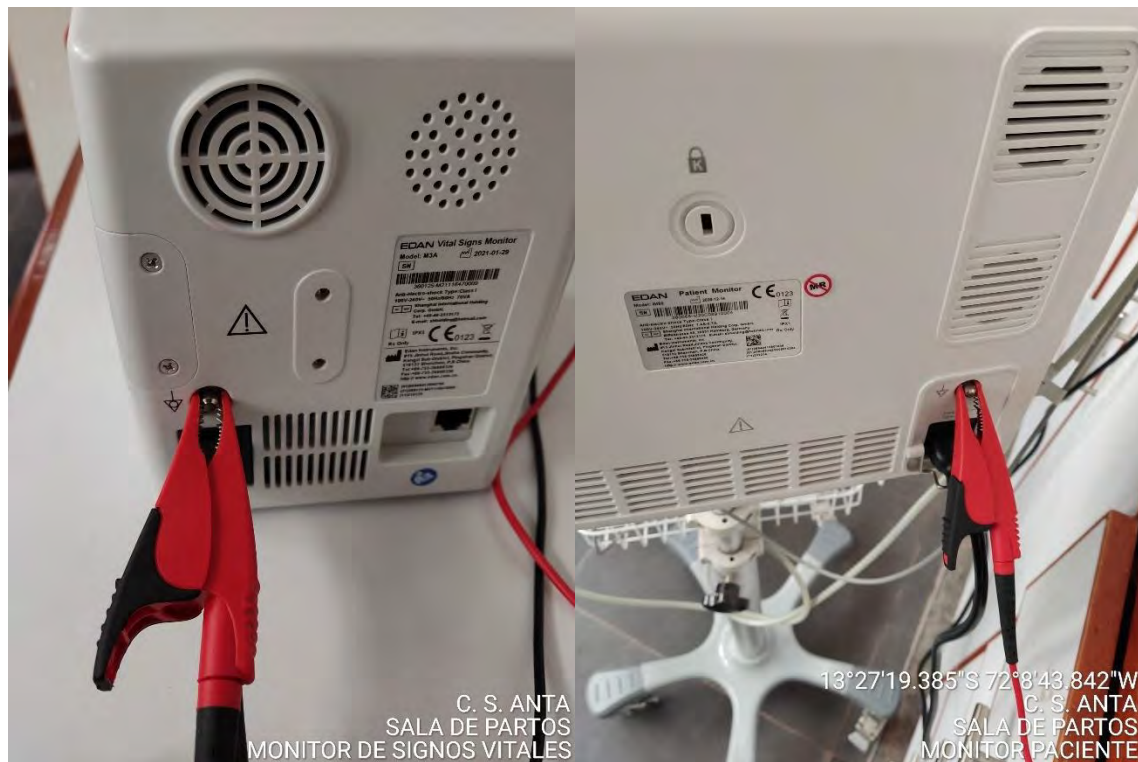
Figura 3 Conexión de la pinza de prueba de color rojo al punto equipotencial del equipo biomédico.
