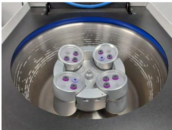
Figura 15. Proceso de centrifugación de las muestras biológicas para la obtención de plasma
