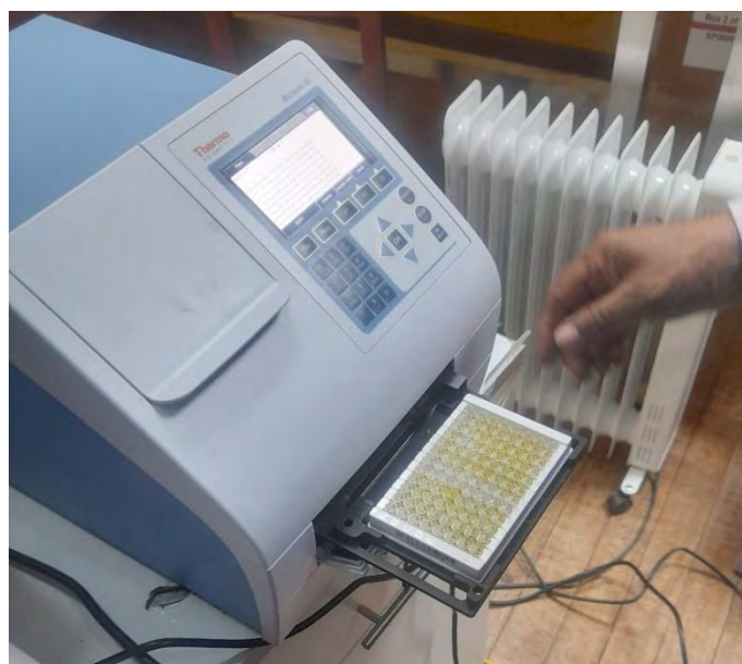
Figura 30. Microplacas de ELISA competitivas para cortisol siendo colocadas en el lector de placas para medir la absorbancia y cuantificar la concentración de la hormona
