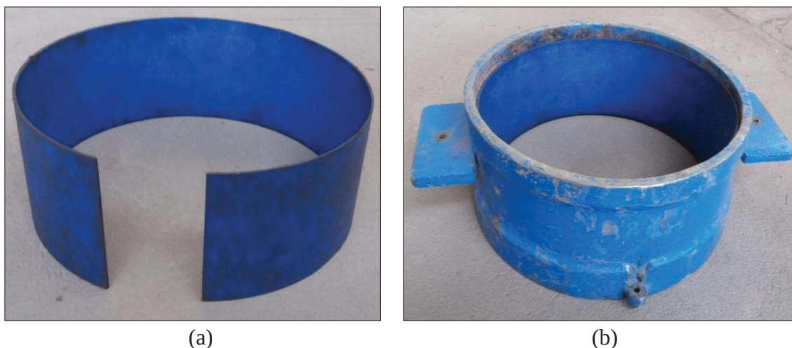
Figura 44 a) Anillo de polietileno (plástico) de 11 cm de altura, b) Colocación del anillo de polietileno en la caja de corte superior.
