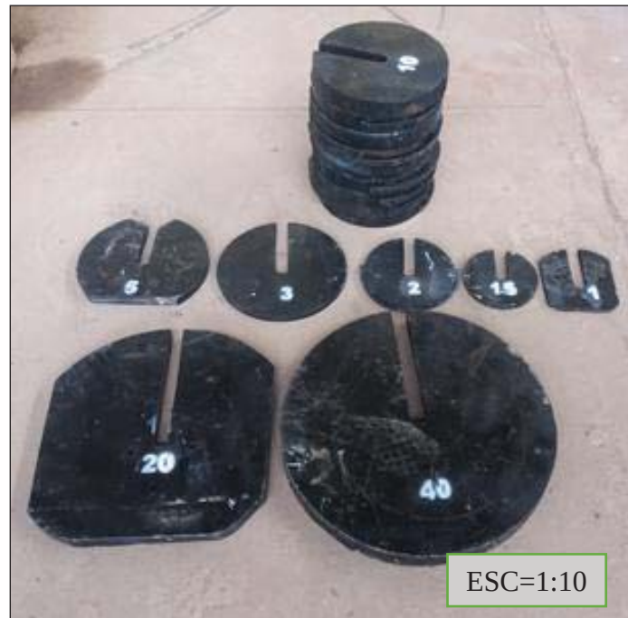
Figura 20 Conjunto de pesas para la fuerza normal.
