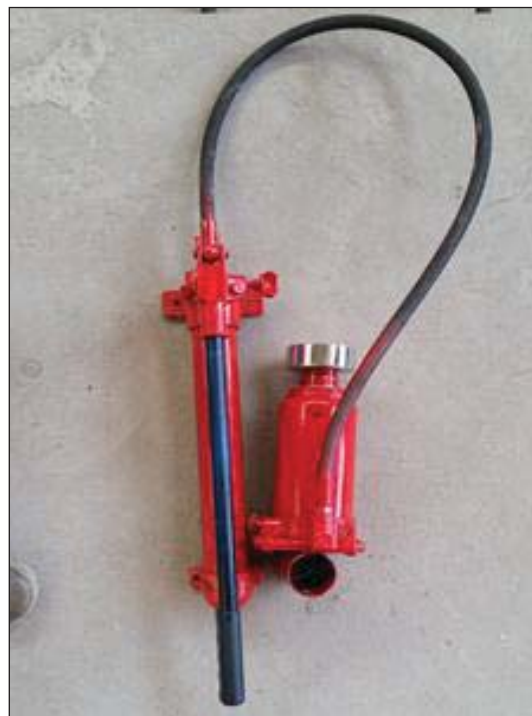
Figura 17 Adaptación del inyector de presión al gato hidráulico.
