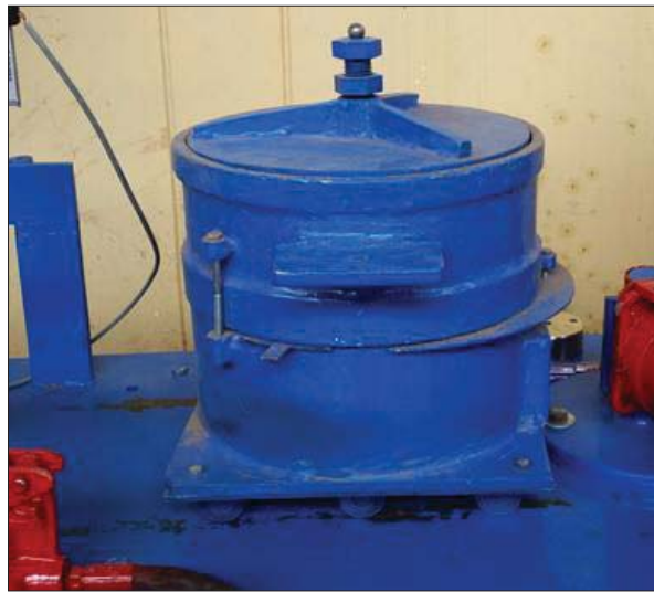
Figura 48 Colocación del disco distribuidor de carga y la bola de acero.
