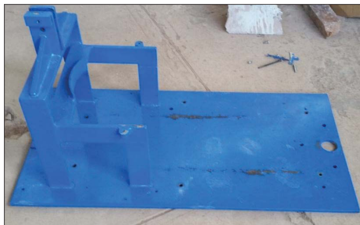
Figura 12 Plataforma de acero con el soporte de caja de corte.
