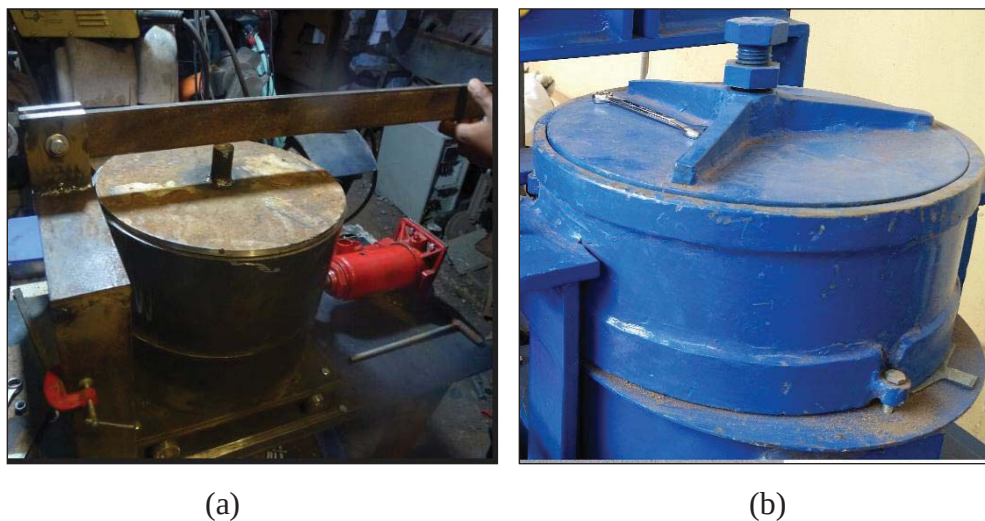
Figura 8 a) ensayo de prueba en la primera etapa en donde la caja de corte, disco transmisor de carga ni el brazo de palanca es reforzado, b) disco distribuidor de carga axial con refuerzo.
