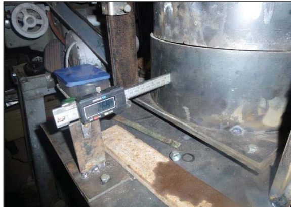
Figura 11 Registro de deformaciones con el vernier digital.
