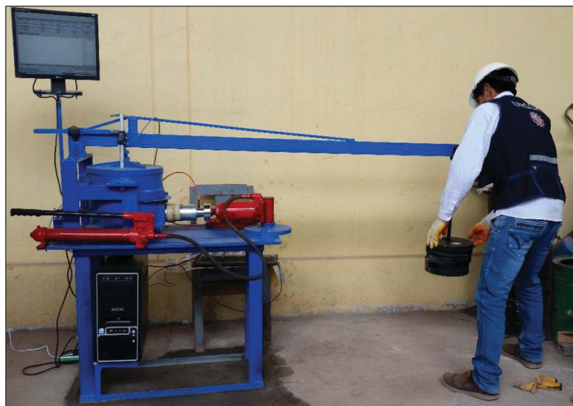
Figura 56 Colocado de pesas para la fuerza normal.
