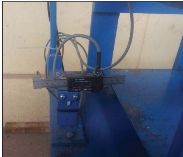
Figura 24 Vernier para la medición de la deformación tangencial.
