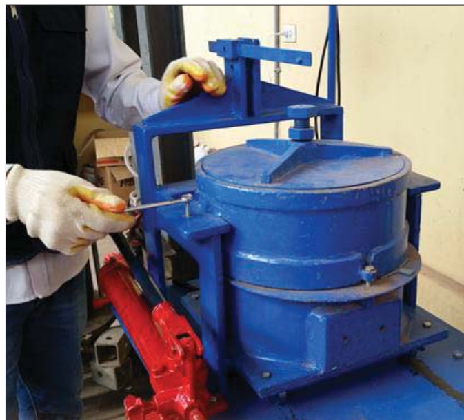
Figura 49 Fijación de la caja de corte superior.
