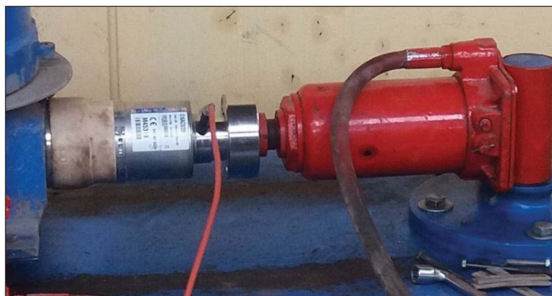
Figura 23 Medición de la fuerza tangencial con la celda de carga.
