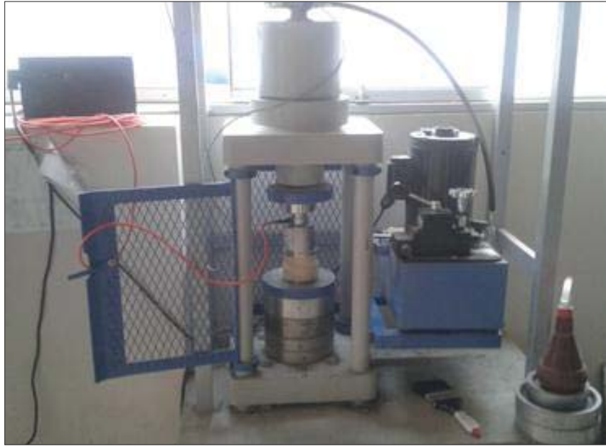
Figura 39 Calibración de a celda de carga.
