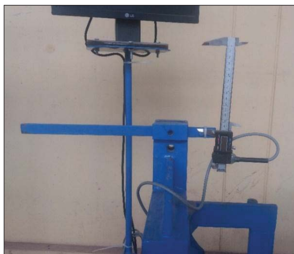
Figura 25 Vernier para la medición de la deformación vertical.
