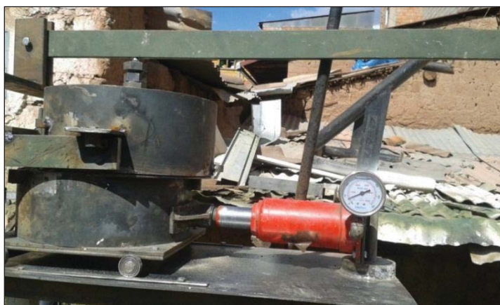
Figura 10 registro de la fuerza tangencial con la adaptación de un manómetro en el gato hidráulico.
