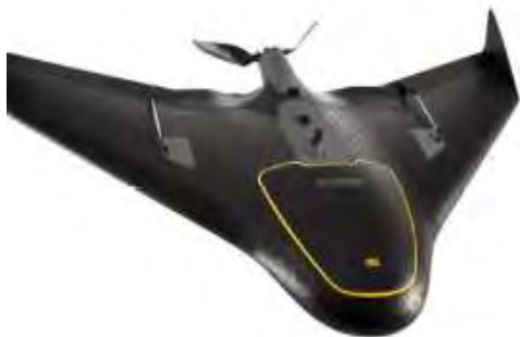
Figura 2: Drone de ala fija Trimple XU-5 de 1m de envergadura de alar.
