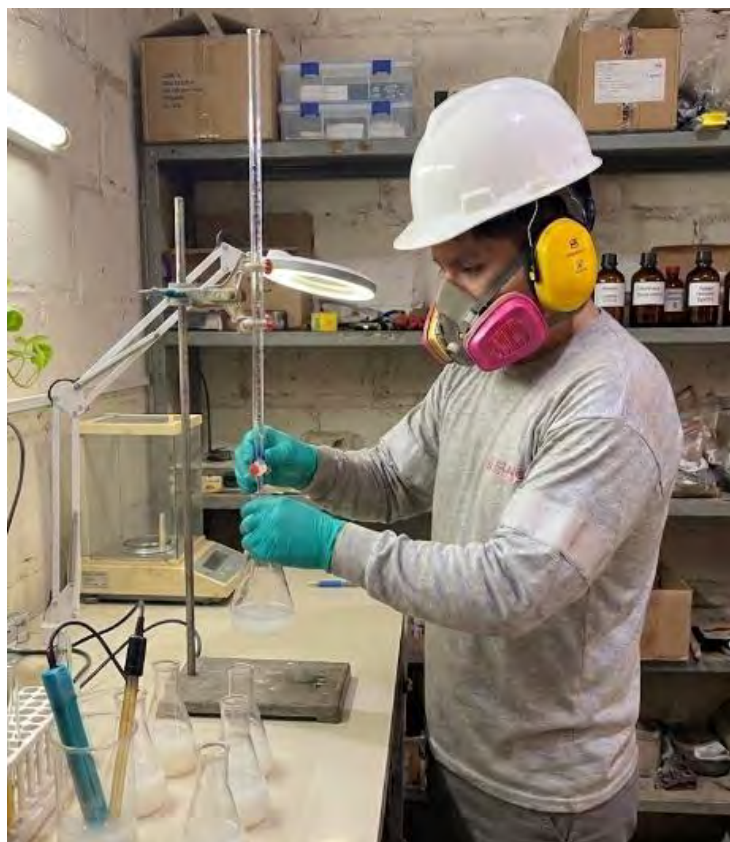
Fotografía 9. Determinación de fuerza de cianuro mediante titulación
