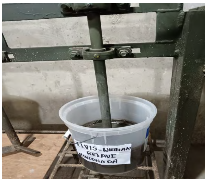
Fotografía 10. Agitación del relave por método de cianuración
