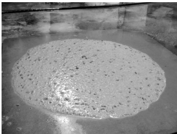
VSI=2 - Evidencia de un halo de mortero y brillo de agua
