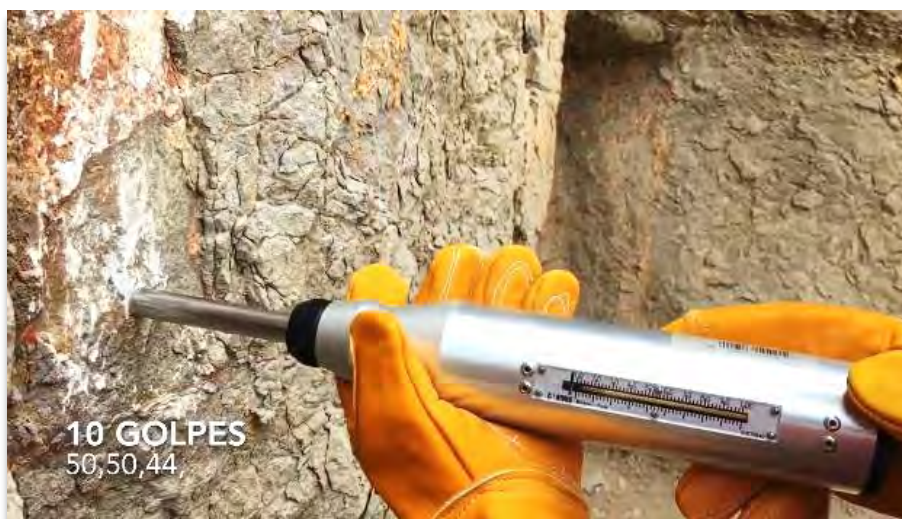
Figura 20: Toma de numero de rebotes con martillo de Schmidt
