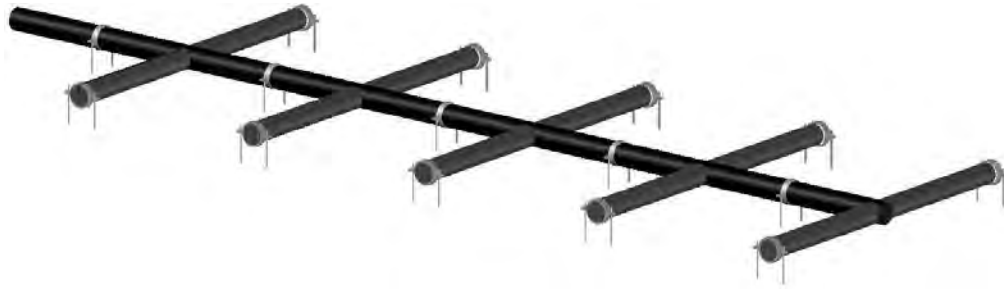
Figura 18. Implementación de sistema en soporte de tipo varilla con abrazaderas. Fuente: elaboración propia.
