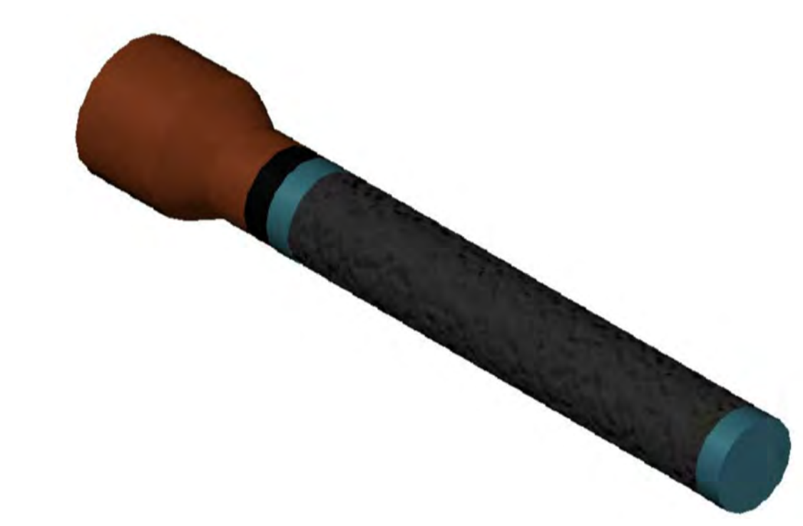
Figura 12. Boceto del diseño geométrico del difusor de burbuja fina. Fuente: elaboración propia.
