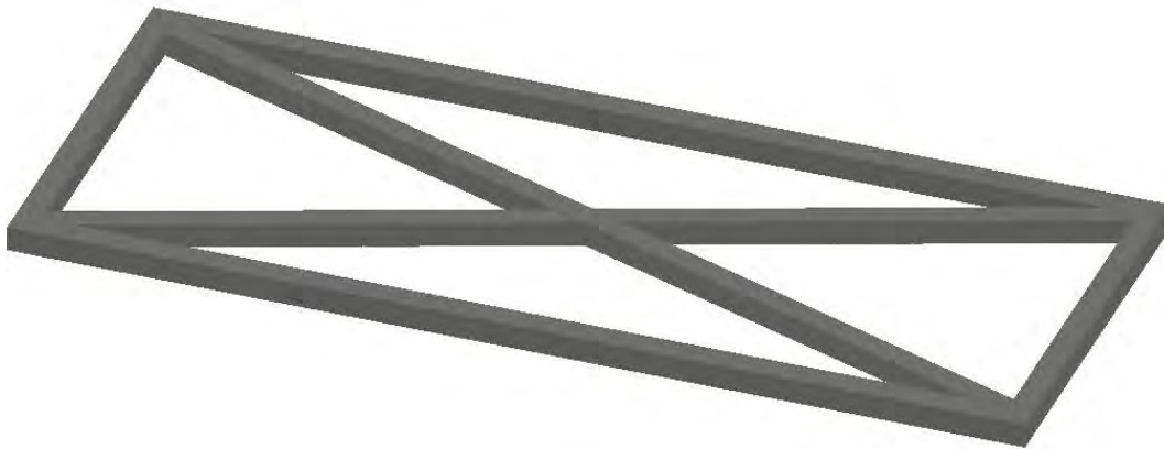
Figura 15. Soporte de tipo parrilla. Fuente: elaboración propia.
