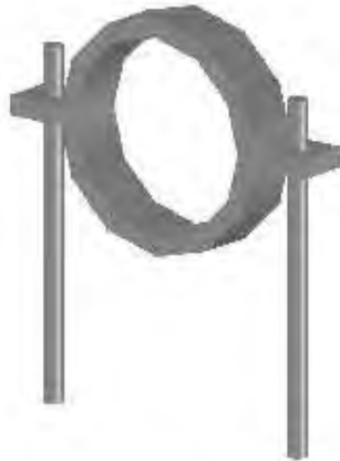
Figura 17. Soporte de tipo varilla con abrazaderas. Fuente: elaboración propia.
