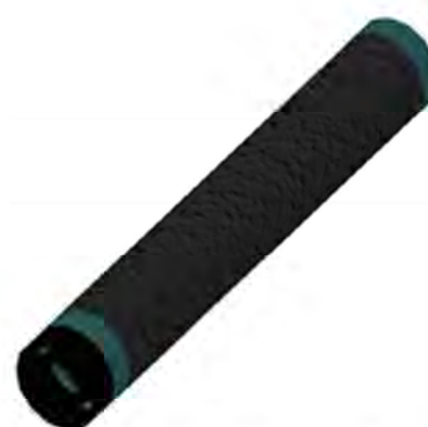
DIFUSOR DE BURBUJA VISTA ISOMETRICA ESCALA 1:20
