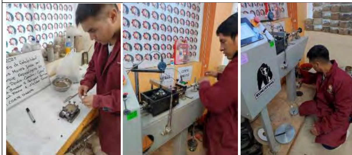
Fotografía 20 Ensayo de Corte Directo
