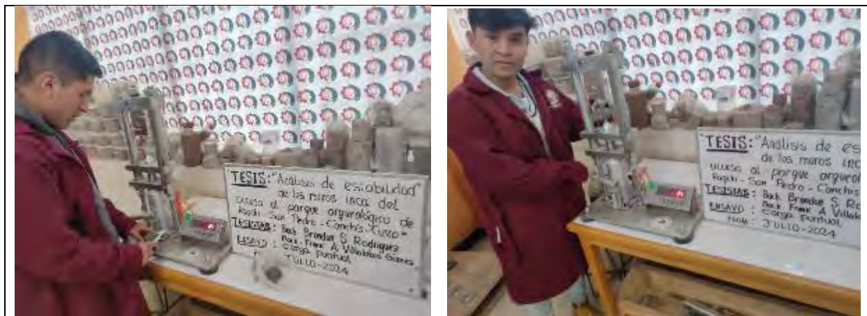
Fotografía 22 Ensayo de Carga Puntual en Rocas
