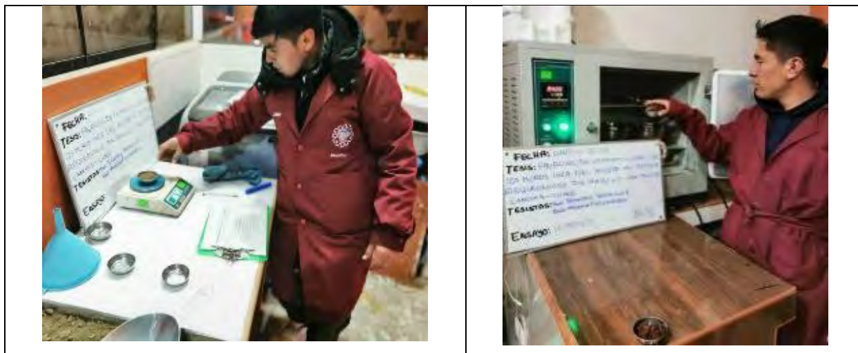
Fotografía 16 Ensayo de Humedad
