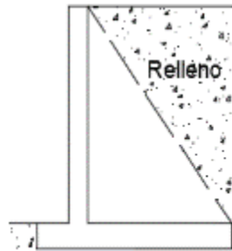
c) Muro con contrafuertes posteriores
