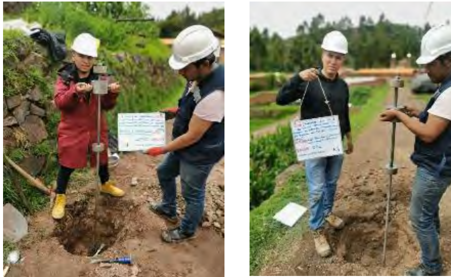
Fotografía 6 Ensayo de penetración dinámica ligera (DPL)
