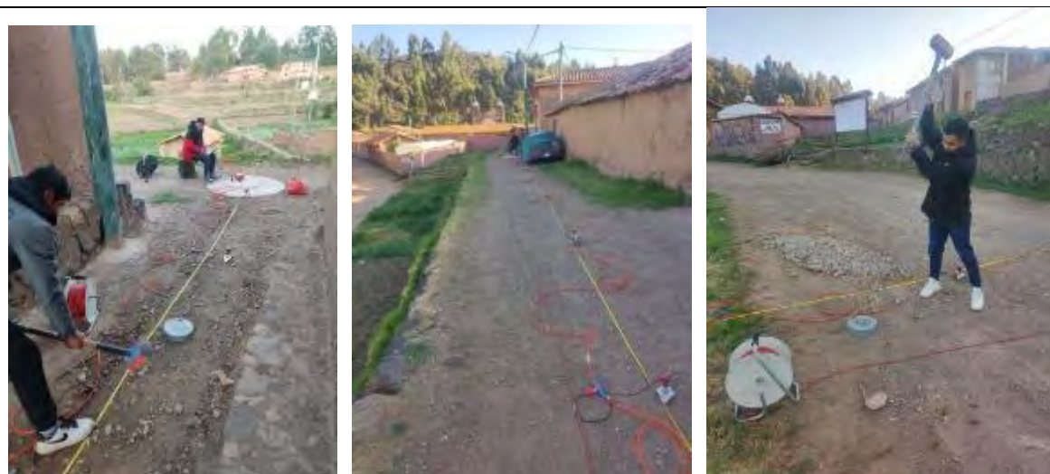
Fotografía 24 Ensayo de MASSW2D
