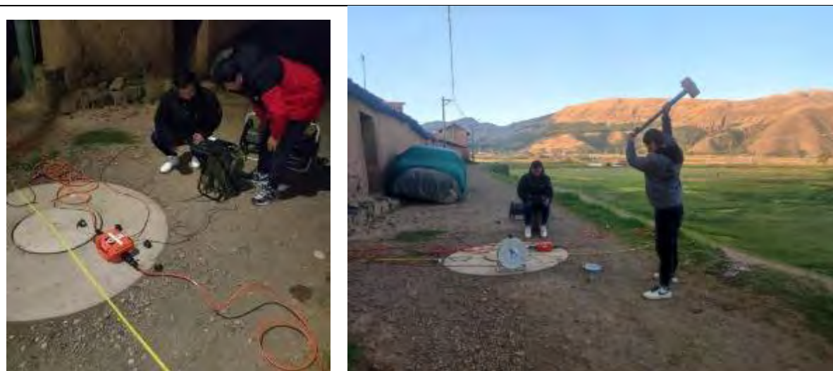
Fotografía 23 Ensayo técnico geofísico de refracción sísmica
