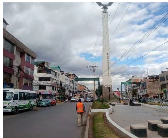
Medición de progresivas y reconocimiento del tramo de estudio mediante el uso de odómetro, para la delimitación e identificación de los subtramos de evaluación.
