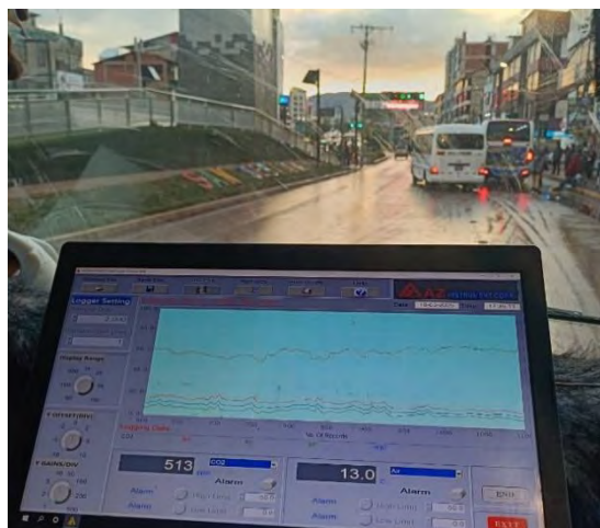
Se observa el funcionamiento del programa para el registro y almacenamiento de datos, así como la visualización de gráficas en la laptop, durante pruebas previas al registro oficial en el tramo de estudio.
