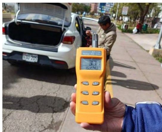
Se observa el vehículo de prueba y el equipo sensor durante las evaluaciones, realizando mediciones a diferentes distancias del escape vehicular para verificar el funcionamiento del equipo de monitoreo.
