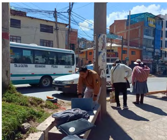
Registro de concentraciones de CO 2 realizado en el subtramo Enaco durante el monitoreo en campo.
