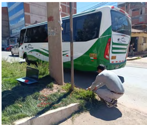
Registro de concentraciones de CO 2 en el subtramo Segundo Paradero, correspondiente al pavimento rígido, durante el monitoreo de campo.
