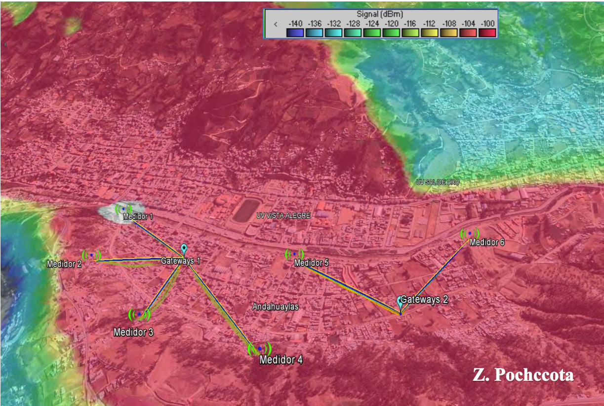
Figura 38 Simulación de señal LoRaWAN con RadioMobile zona Pochccota
