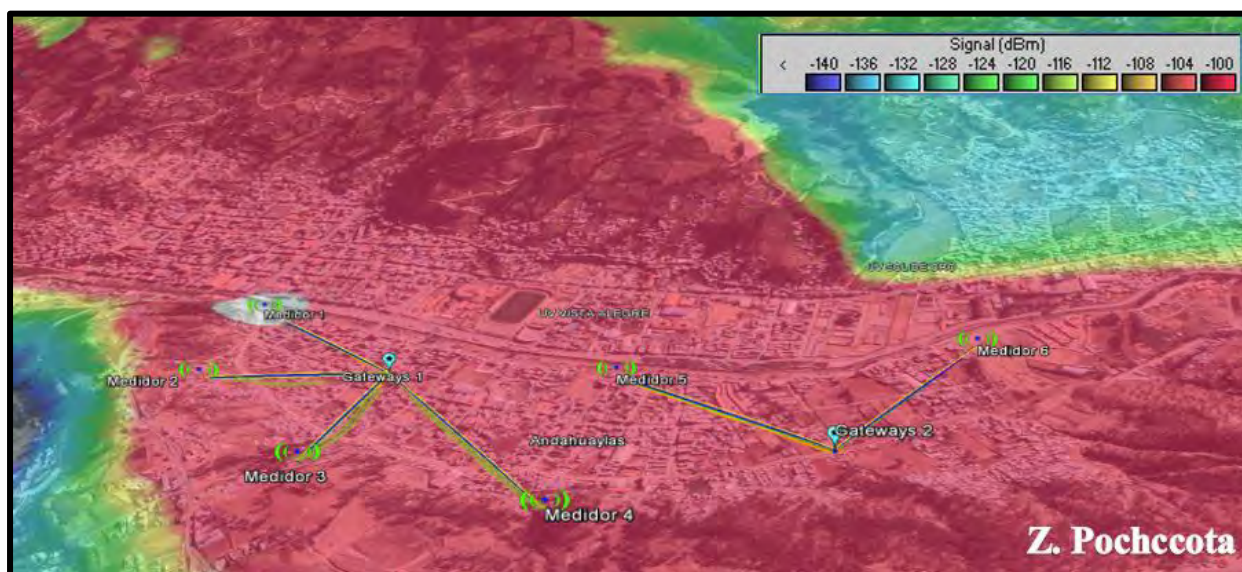
Figura 57 Simulación Teórica con RadioMobile
