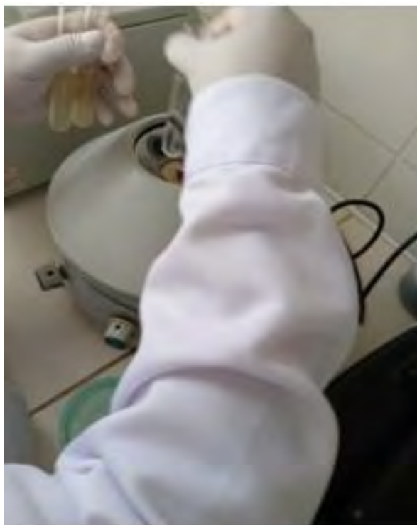
Fotografía 22. Centrifugación del filtrado de la solución de la raíz de Ilacón ( Smallanthus sonchifolius (Poepp.) H.Rob).
