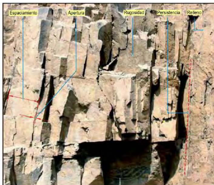
Ilustración 20. Esquema de las propiedades de las discontinuidades
