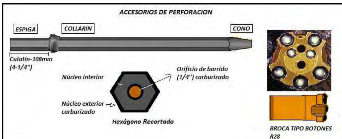
Ilustración 48. Partes de un Barreno.
