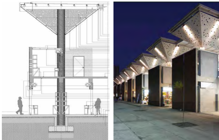
Figura n° 92 y 93: Vista de las columnas metálicas y de talle de techo FUENTE: https://www.floornature.es
