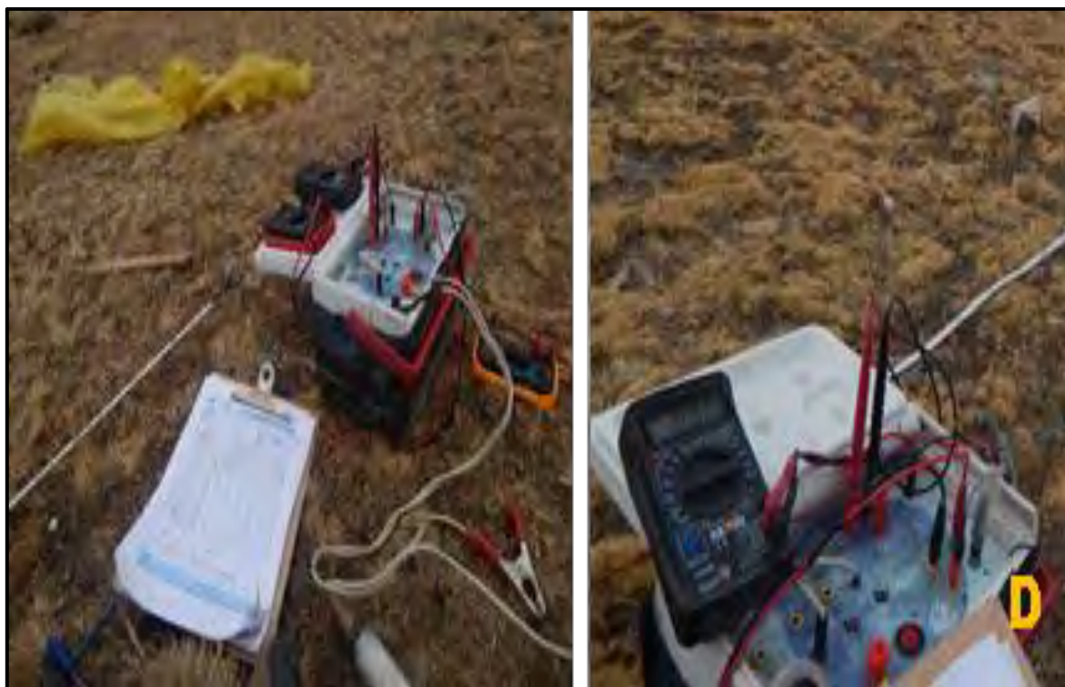
Figura 52 Medición con el equipo geoelectrico de resistividad
