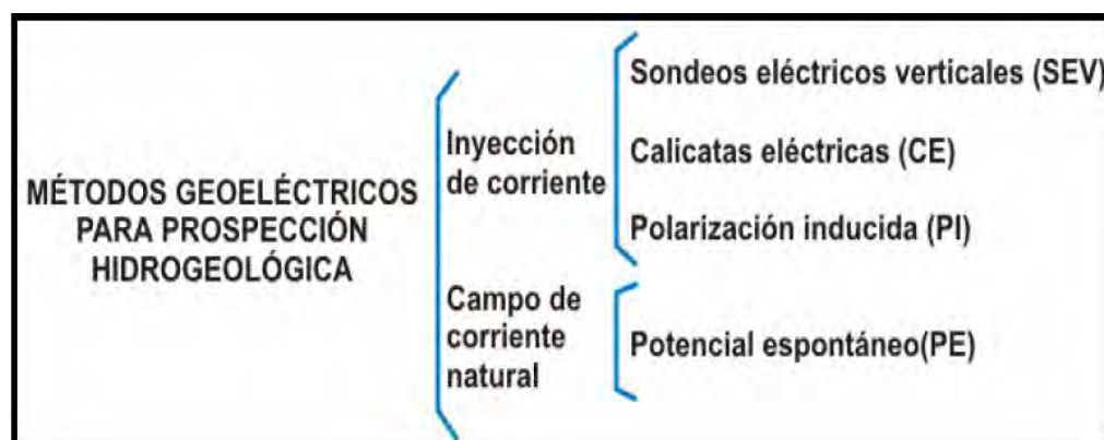
Figura 8 Métodos geoelectrónicos de prospección hidrogeológica
