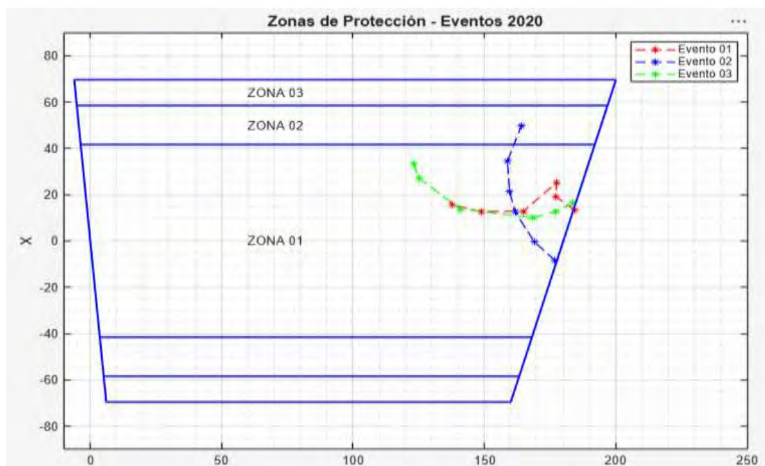
Figura 28 Diagramas de impedancia de los eventos de operación incorrecta sobre las zonas de protección de la LT-6002 (2020).
